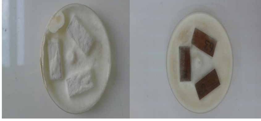
Şekil 7: Kontrol - Emprenye + Isıl işlem örnekleri.
