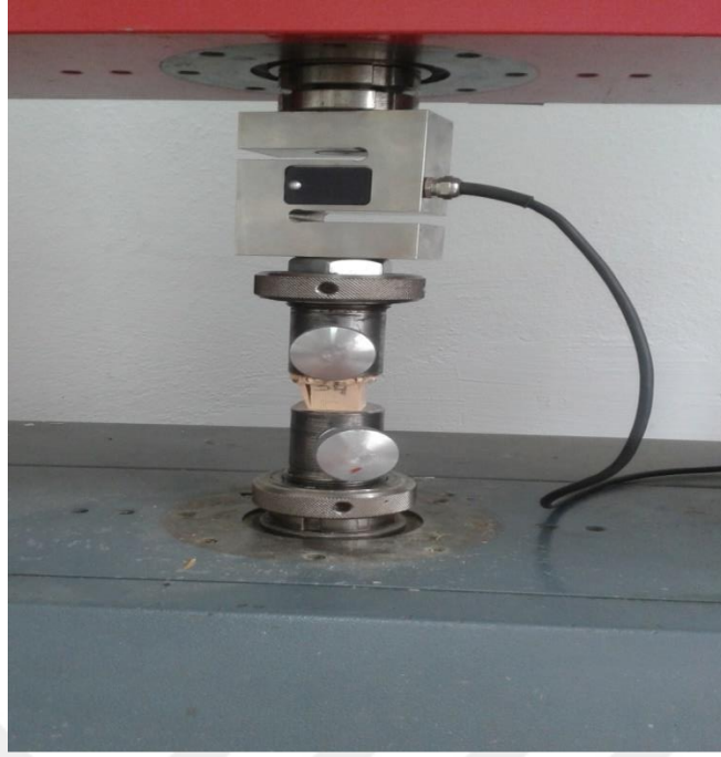
Şekil 5: Basınç direnci testi.
