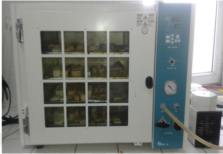
Şekil 2: Isıl işlem düzeneği.
