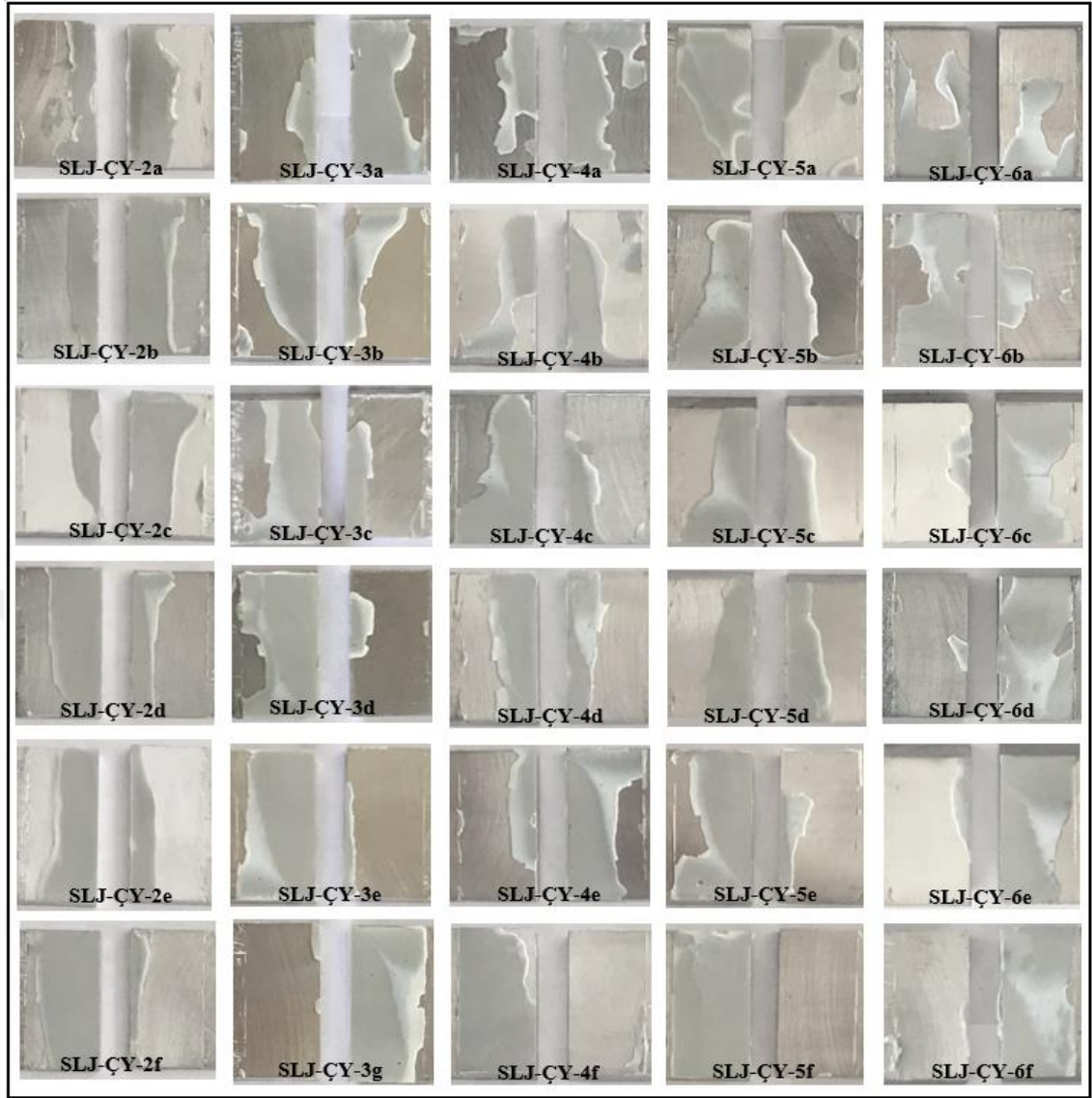
Şekil 4.7. Çeki yorulma yüküne maruz yapıştırma bağlantılarının hasar yüzeyleri.
