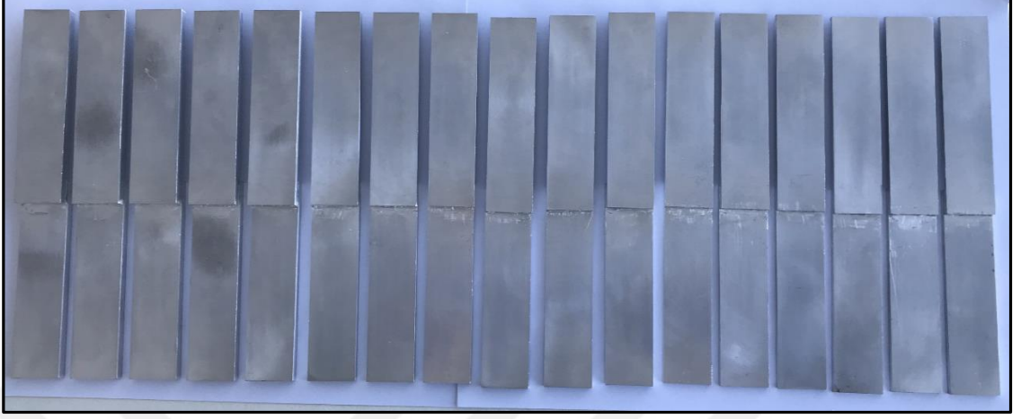
Şekil 3.15. Üretimi tamamlanmış tek tesirli bindirme bağlantıları.
