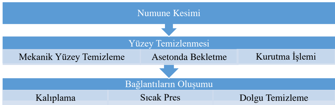
Şekil 3.6. Numune hazırlama işleminin şematik gösterimi.
