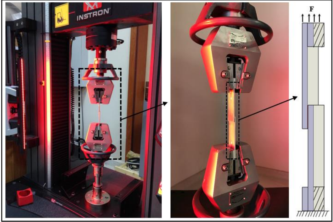
Şekil 3.16. Üniversal test cihazı ve sınır şartları.
