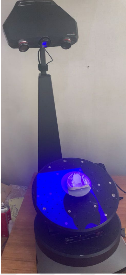
Şekil 3-5: Solutionix C500 tarayıcı ile referans modelin elde edilmesi
