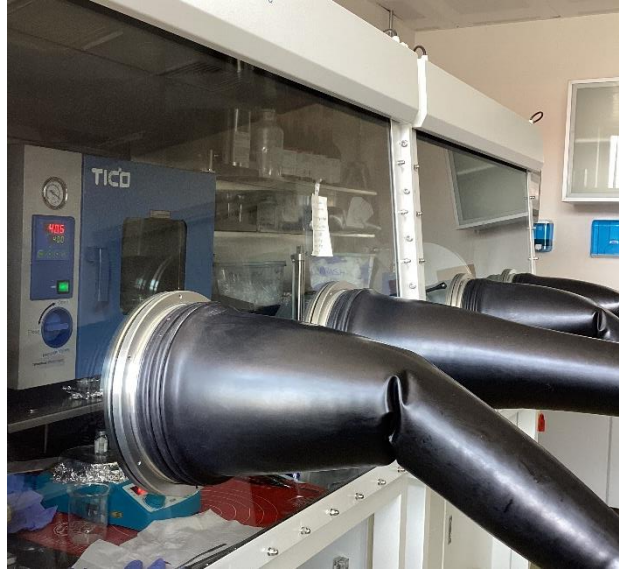
Şekil 3.3. Glovebox ( H_2O , O_2 < 0,2 ppm).
