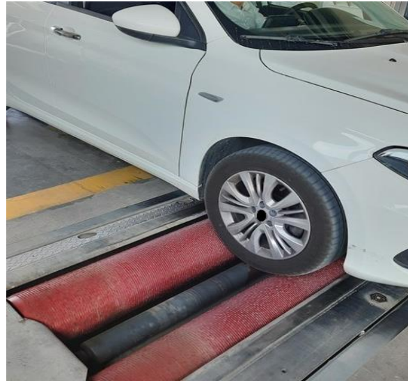
Resim 3.4 Fren test aracı ile fren testini gerçekleştirilmesi sağdan görünüm.
