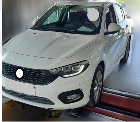
Resim 3.3 Fren test aracı ile fren testini gerçekleştirilmesi soldan görünüm.
