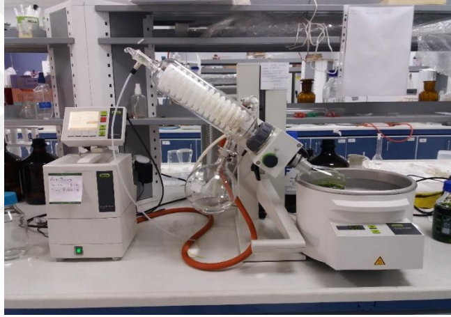
Şekil 3.4. Ekstrelerdeki çözücülerin rotavaporla uzaklaştırılması
