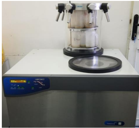
Şekil 3.5. Sulu ekstrenin liyofilizatörde kurutulması (Freeze Dryer)
