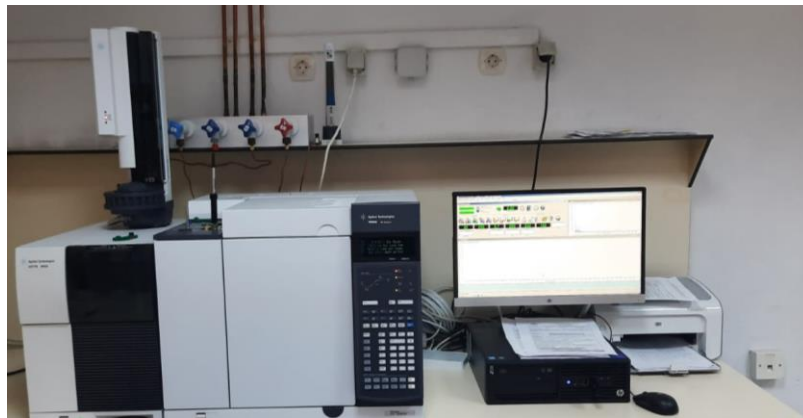
Şekil 3.6. GC-MS ve GC-FID sistemi
