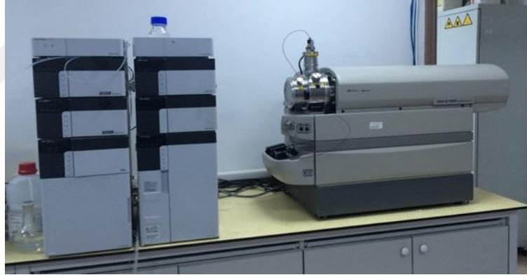
Şekil 3.7. Shimadzu 20A HPLC - ABSciex 3200 Q trap MS/MS
