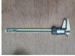
Şekil 3.5 Tane Şekil ve Boyutlarının Ölçümünde Kullanılan Kumpas
