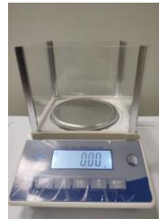
Şekil 3.4 Elektronik Hassas Terazı
