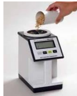
Şekil 3.1 PM 450 dökmeli tahıl nem ölçüm cihazı
