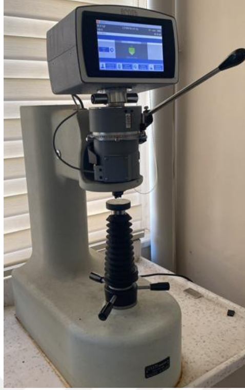
Şekil 3.8. Sertlik ölçüm cihazı
