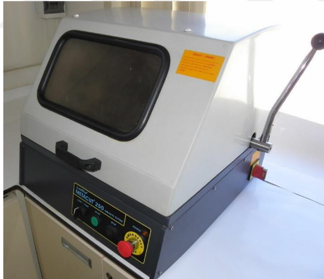
Şekil 3.4. Hassas kesme cihazı
