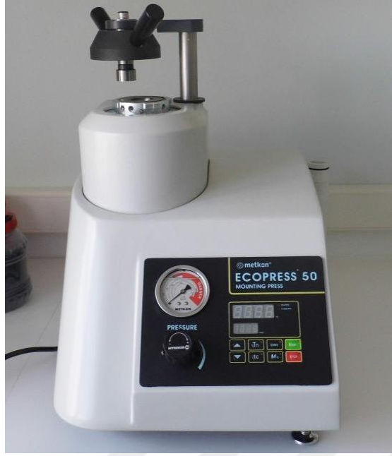
Şekil 3.5. Bakalite alma cihazı
