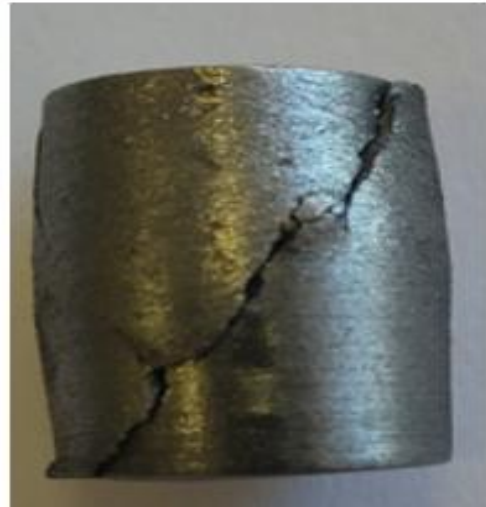
Şekil 4.3. Basma deneyi kırılma hasarları
