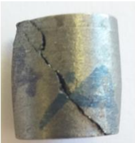
Şekil 4.3. Basma deneyi kırılma hasarları
