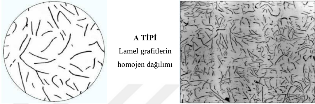
Şekil 2.2. Lamel grafitli dökme demir (A tipi)
