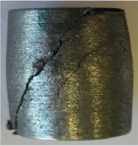
Şekil 4.3. Basma deneyi kırılma hasarları (şekillerin devamı)
