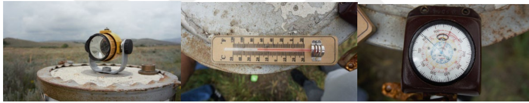
Şekil 7.3. Detay alımında kullanılan reflektör, sıcaklık ve basınç değerlerin ölçen ölçü aletleri.
