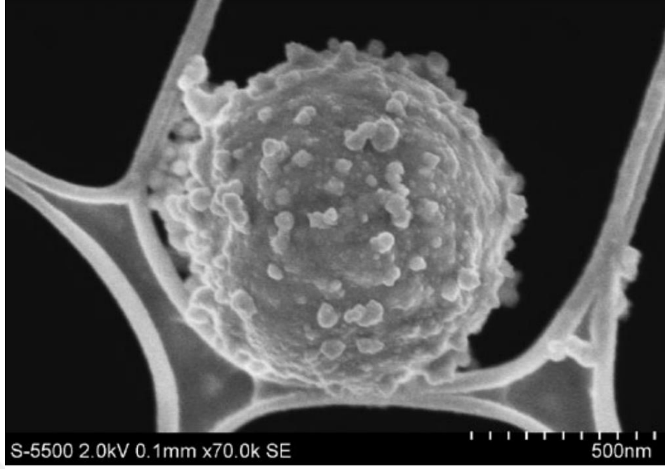
Şekil 2.4. Yüzeyinde küçük parçacıklar bulunan tipik bir GSR parçacığının ikincil elektron görüntüsü (Schwoeble vd., 2011)
