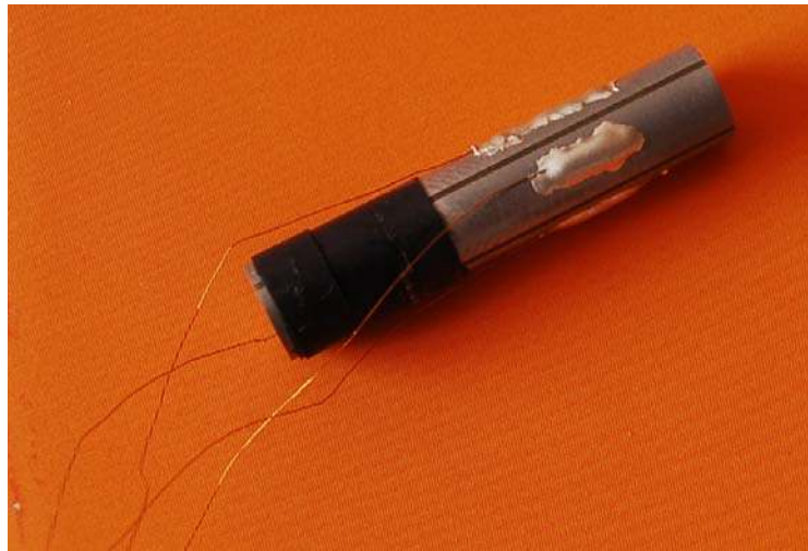
Şekil 4.8 Piezoelektrik tüp ve gerilim telleri.
