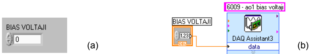
Şekil 4.30 Bias üretimi: (a) Ön panel görüntüsü, (b) blok diyagram içi
