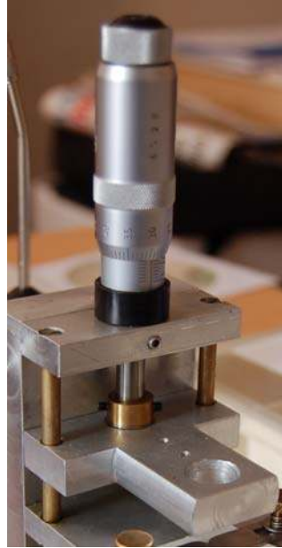
Şekil 4.2 Kaba yaklaştırma mekanizması: (a) Sistemin önden görünüşü, (b) Sistemin yandan görünüşü, (c) Kaba yaklaştırma mekanizmasının sistemde kullanıma hazır hale getirilmiş görüntüsü.
