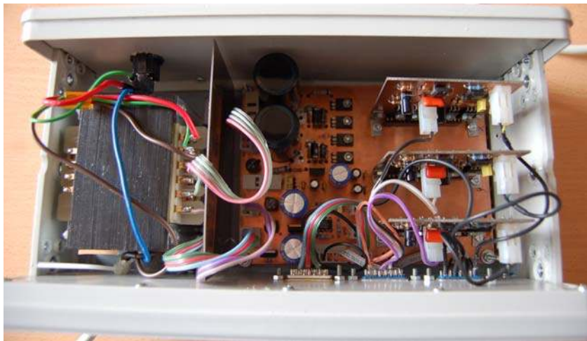
Şekil 4.17 \pm 200V bipolar güç kaynağının elektronik bölümlerinin kutu içerisindeki yerleşimi.
