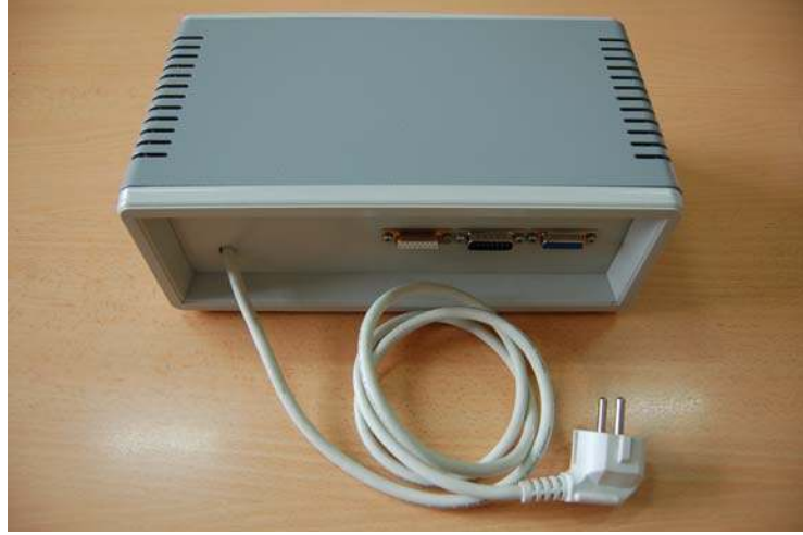
Şekil 4.18 \pm 200V bipolar güç kaynağının kutulanmış şekli.
