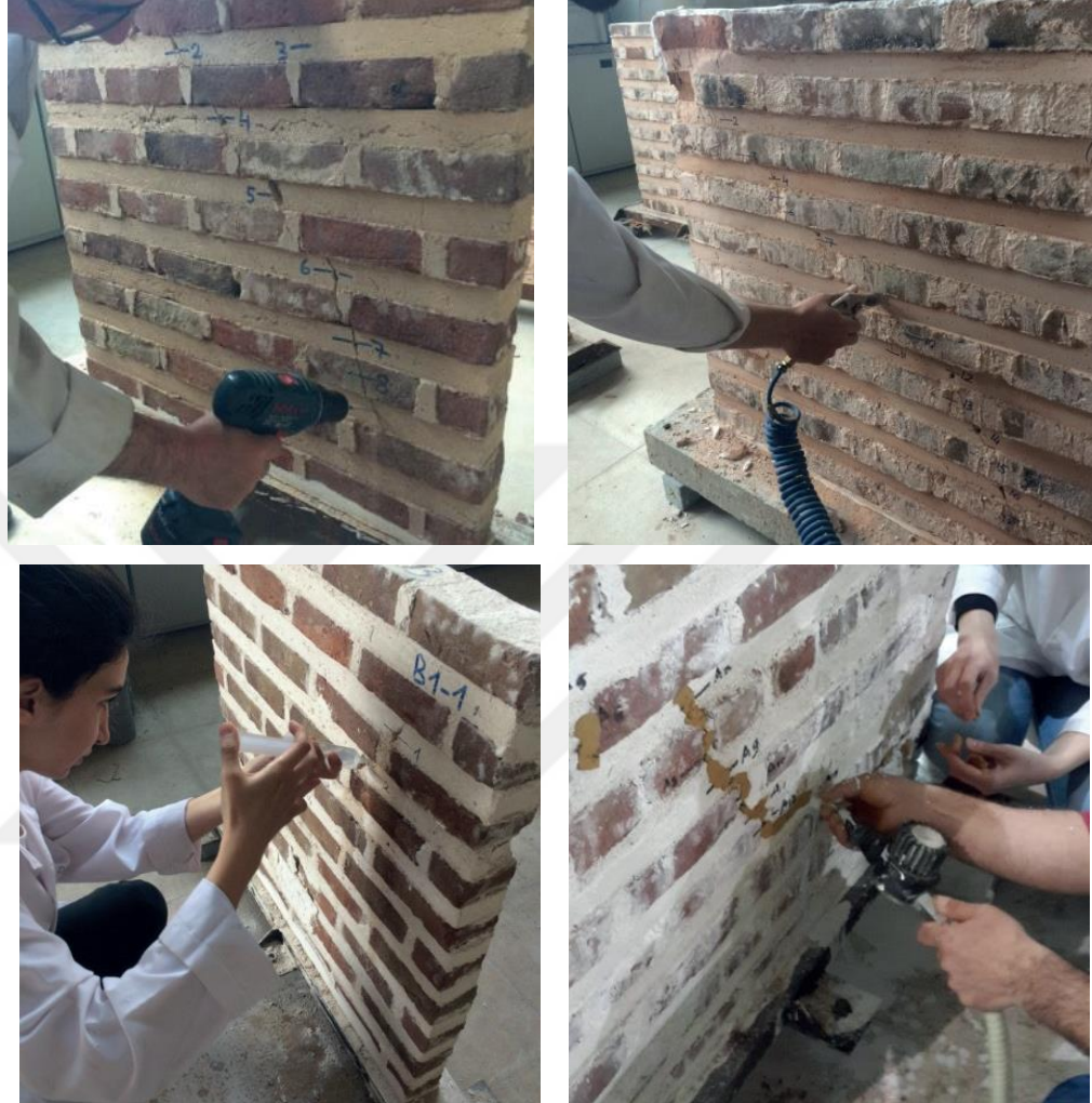
Şekil 45. Enjeksiyon uygulamasına ait aşamalar (TYDRYK, 2017, s. 180).
