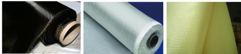
Şekil 61. KFTP, CFTP ve AFTP kumaşlara ait görseller (URL-6).
