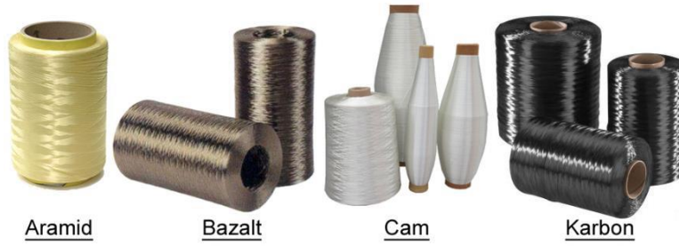
Şekil 50. FTP’de kullanılan bazı lif türleri (Başaran, 2019, s. 29).
