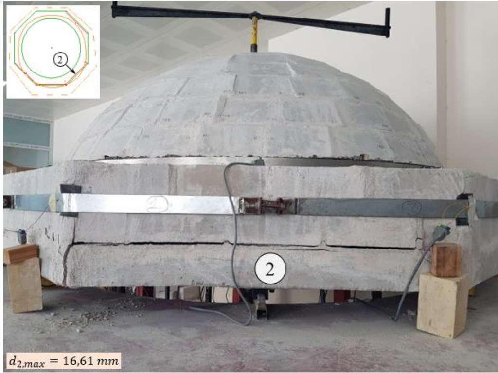
Şekil 4.114. ERSD numunesinin 2. kol üzerinde oluşan çatlaklar.
