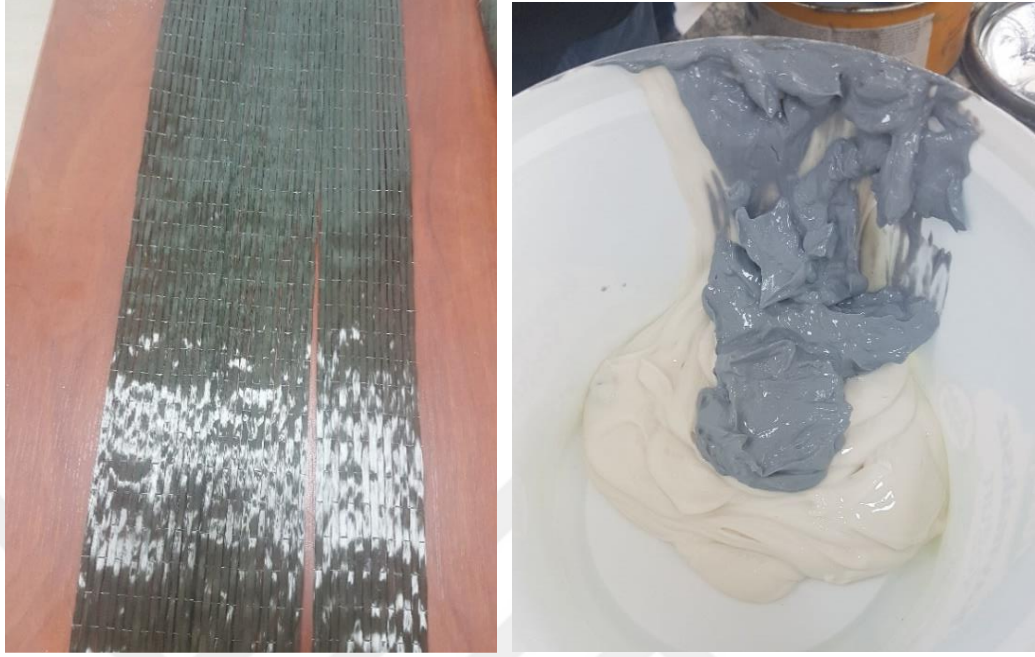
Şekil 3.7. FRP ve 2 bileşenli epoksi.
