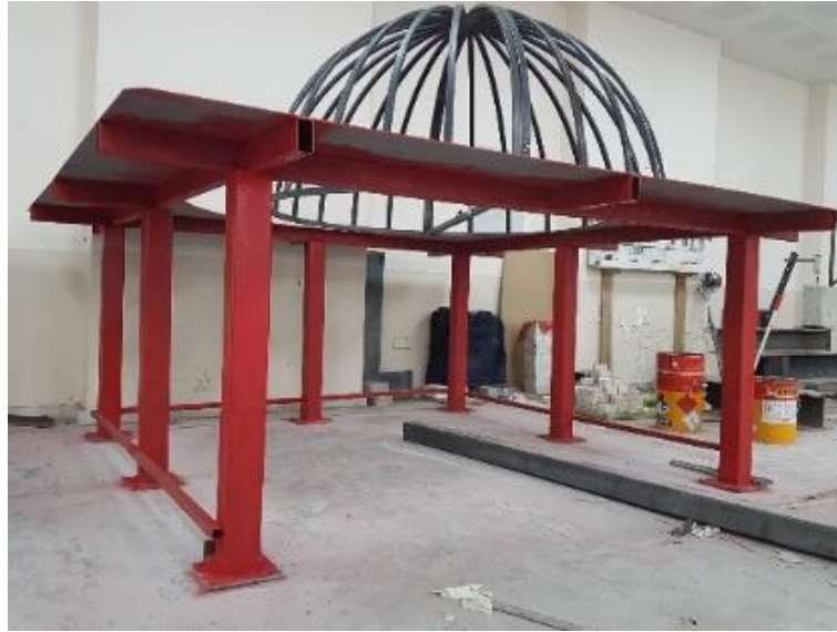
Şekil 3.10. Deney düzeneği üzerine kubbe kalıbının yerleştirilmesi.
