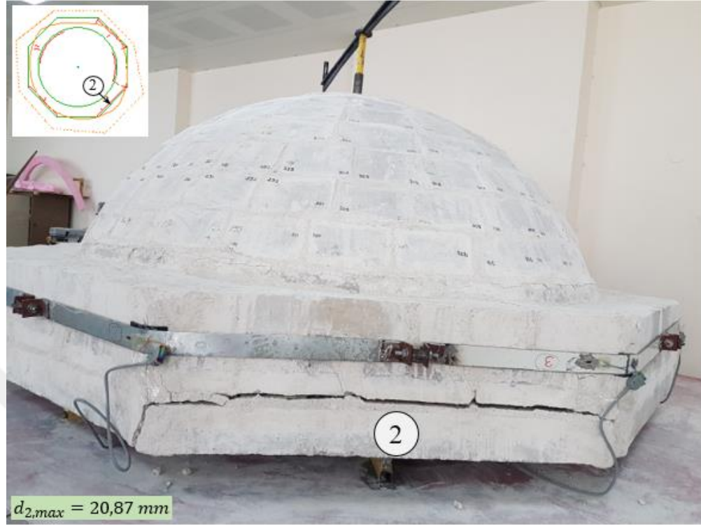
Şekil 4.98. ERD numunesinin 2. kol üzerinde oluşan çatlaklar.
