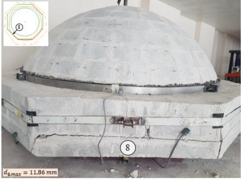
Şekil 4.117. ERSD numunesinin 8. kol üzerinde oluşan çatlaklar.
