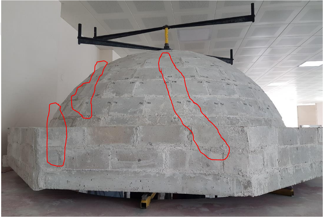
Şekil 3.30. EM deney numunesi ve tamir harcı uygulanan bölgeler.
