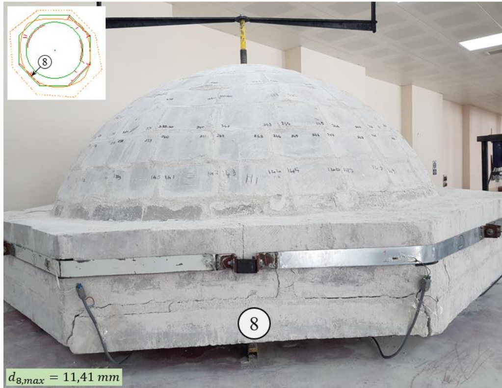
Şekil 4.101. ERD numunesinin 8. kol üzerinde oluşan çatlaklar.
