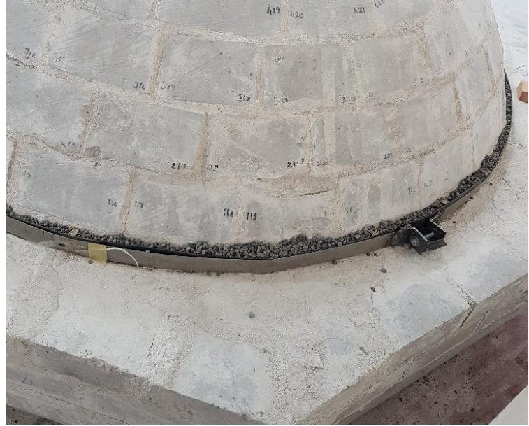
Şekil 3.37. Kubbe eteğine çekme çemberi ve gerinim ölçer yerleştirilmesi.
