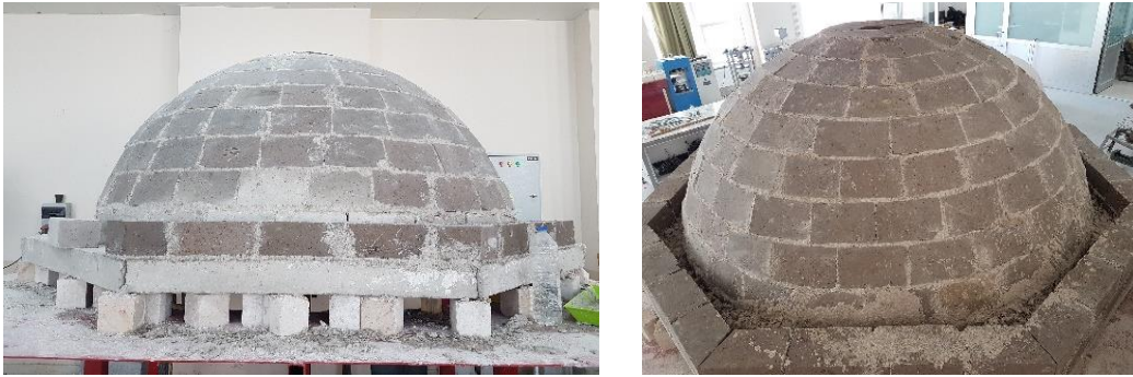
Şekil 3.19. Kubbe kasnağının örülmesi.
