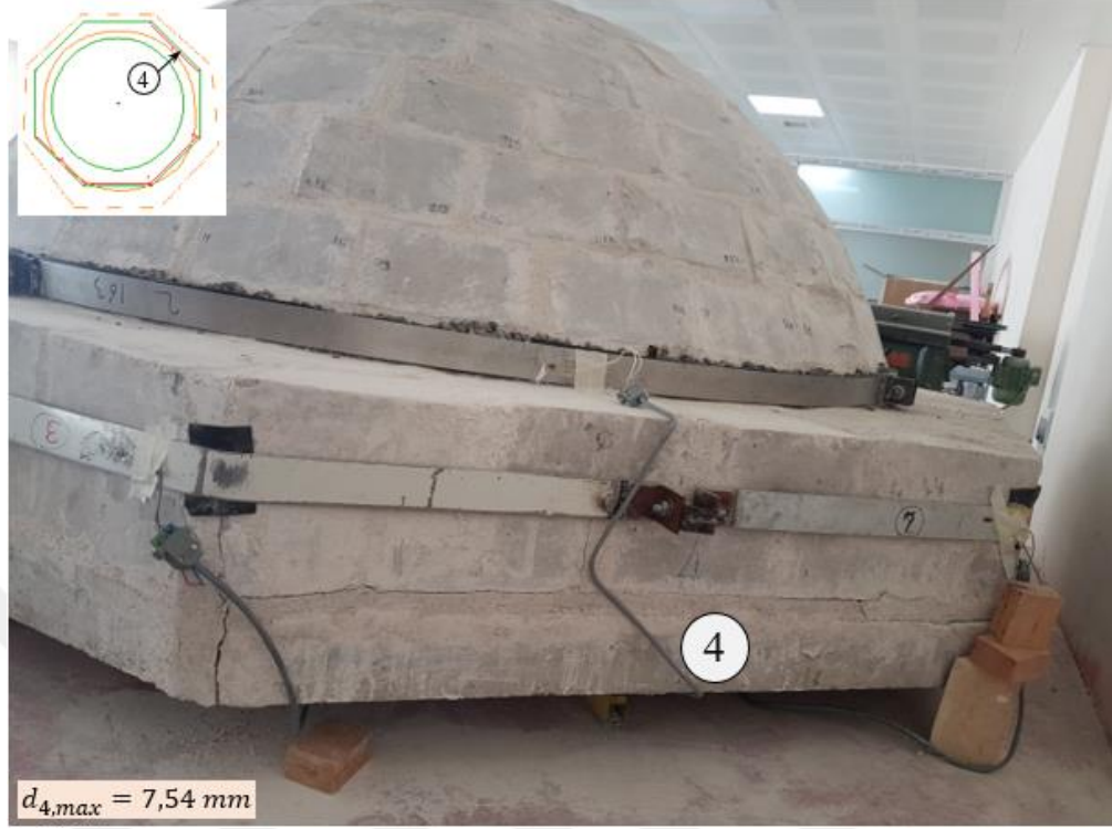
Şekil 4.115. ERSD numunesinin 4. kol üzerinde oluşan çatlaklar.
