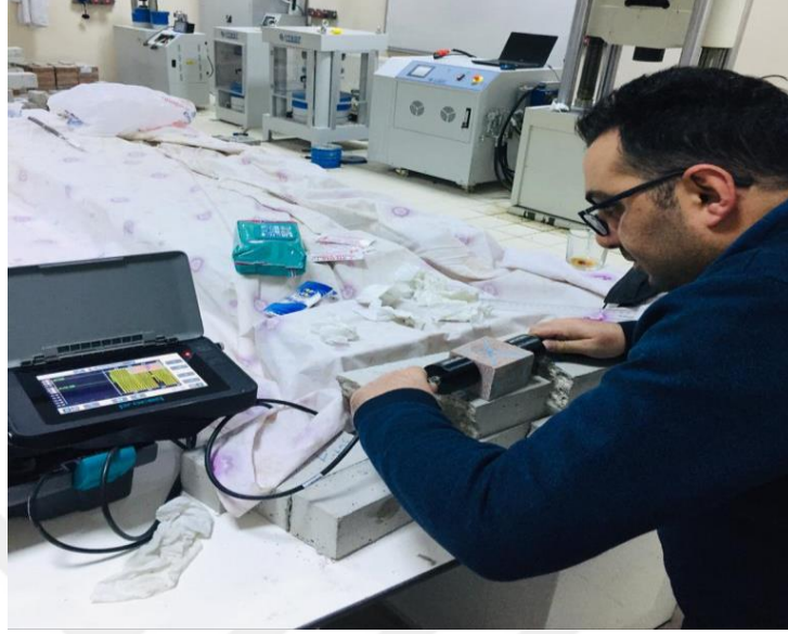
Şekil 3.20. Proceq marka ultrases ölçüm cihazı ile kamber taşı numuneleri üzerinde ultrases geçiş hızı ölçümleri.
