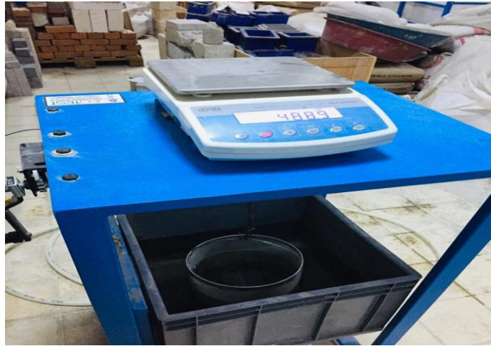
Şekil 3.17. Arşimet terazisi ile kamber taşı numuneleri üzerinde yapılan ölçümler
