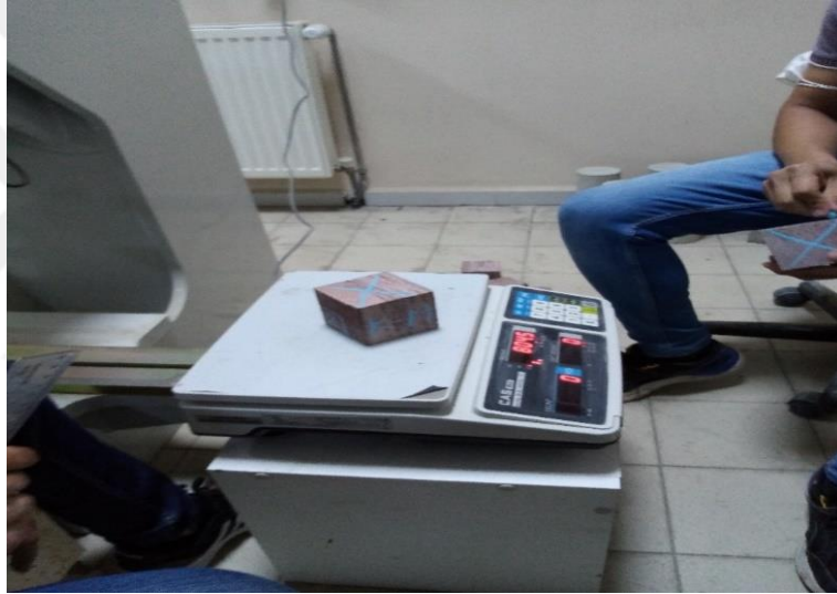
Şekil 3.14. Kamber taşı numunelerin birim ağırlık için kütle ölçümleri
