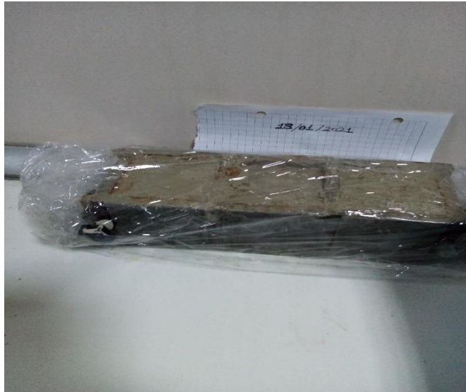
Şekil 3.27. Basınç dayanımı tayini amacıyla hazırlanan killi harç numuneleri
