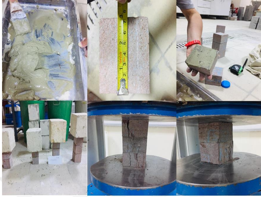
Şekil 3.26. Kamber taşı ile kil harcı kullanarak bloklar hazırlama ve eksenel basınç dayanımı deneyinden görüntüler.
