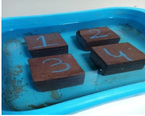
Şekil 3.15. Kamber taşı numunelerinin porozite tayini amacıyla su içinde bekletilmesi
