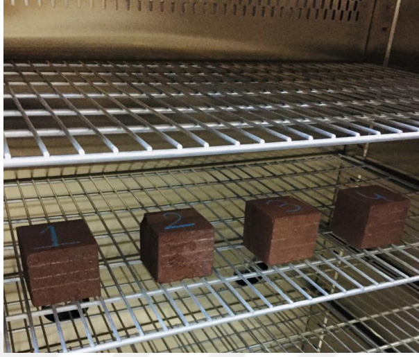
Şekil 3.18. Kamber taşı numunelerinin kurutulma amacıyla etüve yerleştirilmesi
