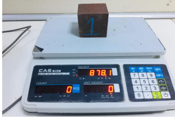
Şekil 3.16. Suyu doygun haldeki kamber taşı numunelerinin ölçülmesi
