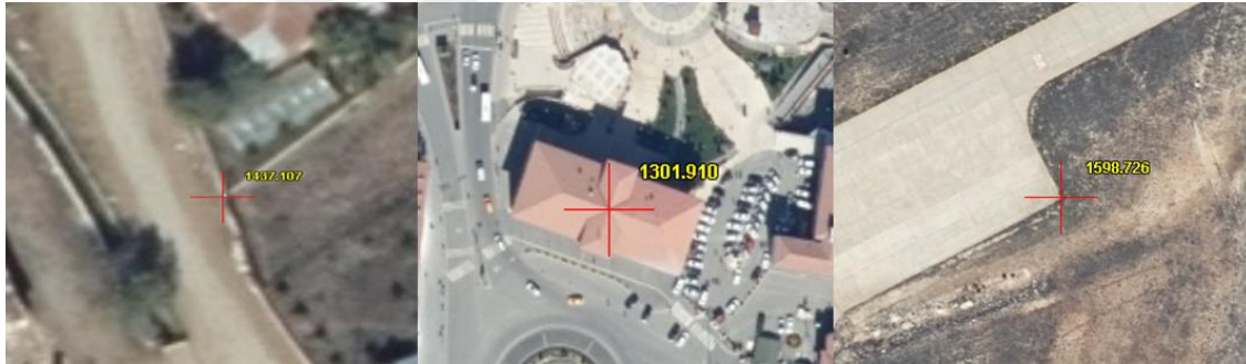
Resim 5.5 Stereo görüntü çiftlerinden elde edilen yer kontrol noktaları.
