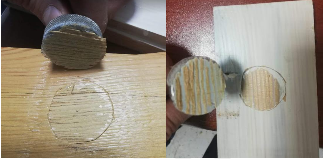
Şekil 3.8: Yüzey sağlamlığı testi kopma örnekleri.
