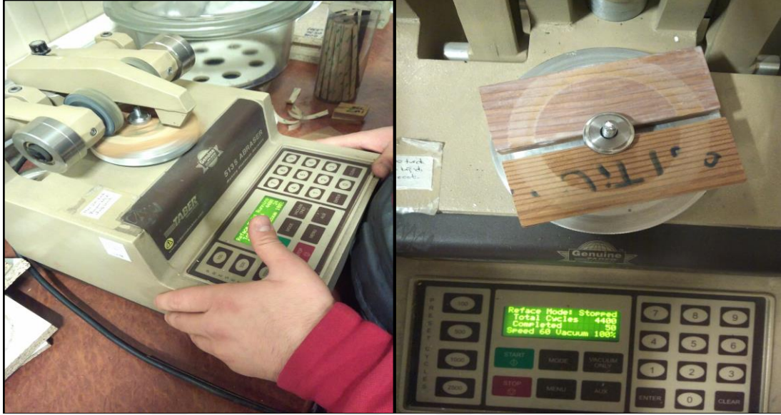
řekil 2.8: Taber ařındırma cihazı ile yapılan ařındırma testi.
