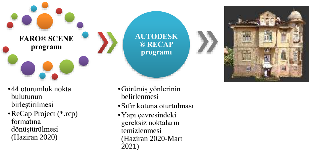
Şekil 5.21. 3D nokta bulutu oluşturulması
