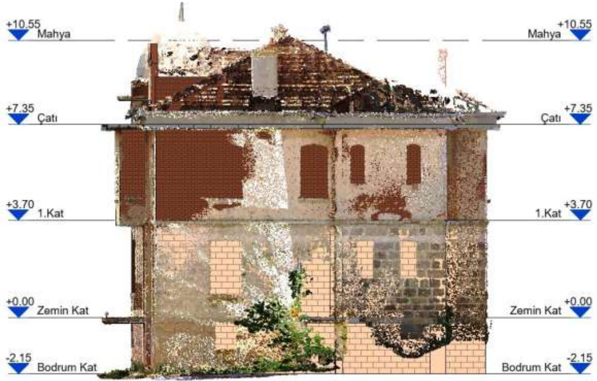
Şekil 7.21. Yapısal elemanları modellenen konağın, nokta bulutu ile karşılaştırılmış görseli - Kuzey cephe
