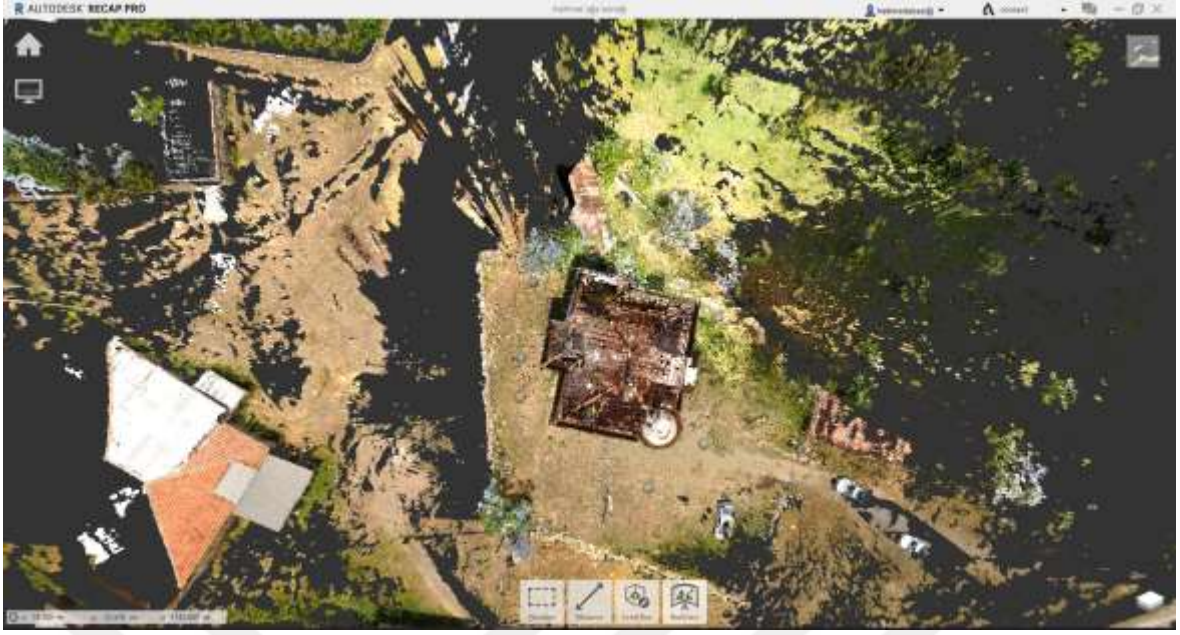
Şekil 5.30. ReCap programına aktarılan nokta bulutu - Vaziyet planı
