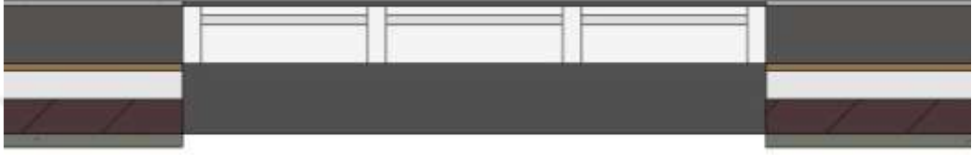
Şekil 8.2. Revit programında katmanların kesilmesi sorunu
