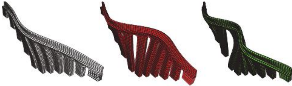
Şekil 2.15. Ponte delle Torri köprüsünün frekans ve periyotlara karşılık gelen mod şekilleri
