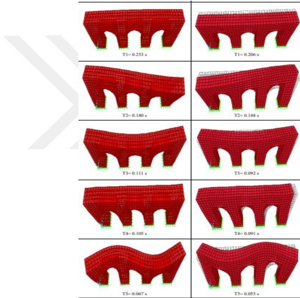
Şekil 2.29. Modal analiz sonucunda periyot değerlerinde meydana gelen azalmalar
