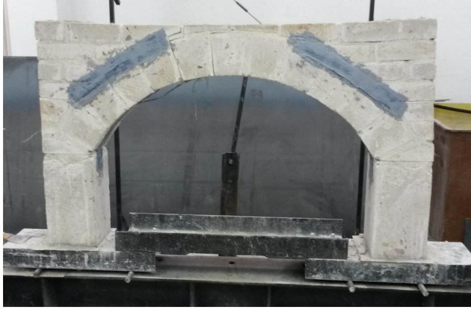
Şekil 4.16 (devam): Model 3 deney numunesinin göçme sonucundaki hali.
