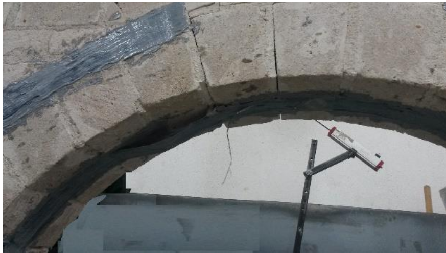
Şekil 4.16: Model 3 deney numunesinin göçme sonucundaki hali.
