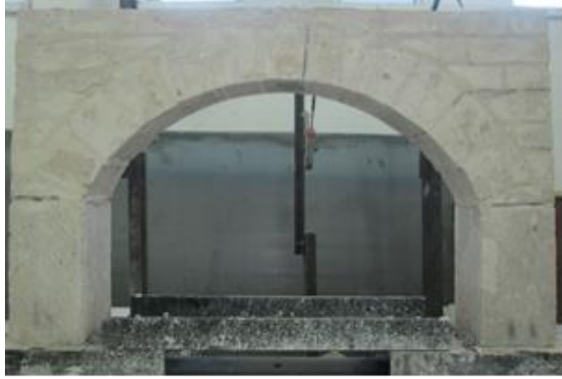
Şekil 4.7: Referans numunenin göçme sonucundaki hali.
