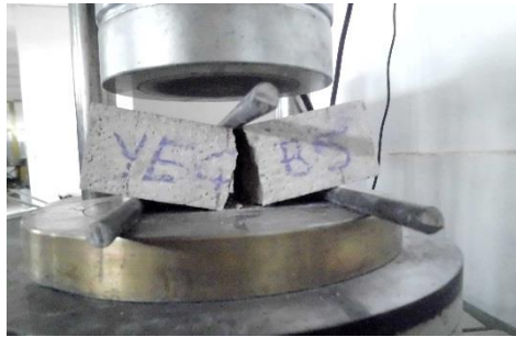
Şekil 3.3: Taşın eğilmede çekme dayanımı testleri (YEÇB1- YEÇB6 numuneleri).
