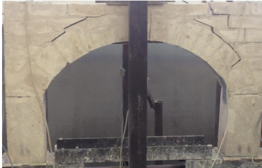
Şekil 4.10: Model 1’de FRP’nin ayrılması ve yükleme sonrası hali.
