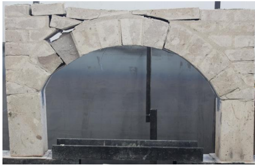
Şekil 4.13: Model 2 deney numunesinin göçme sonucundaki hali.
