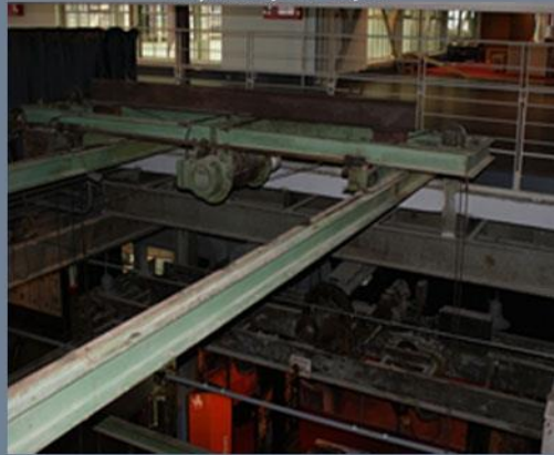
Şekil C: Orijinal vinç sisteminin yerinde mekansal gösterge olarak korunması, kaynak: Çakır arşivi
