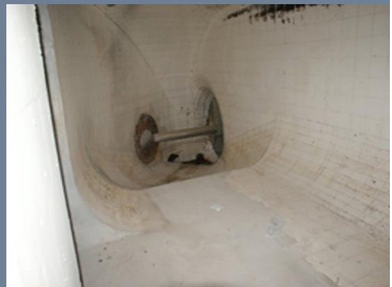
Şekil F: Kağıt hamurunun kıvamını ayarlayan karıştırıcı mikserlerin yerinde korunması Kaynak: Çakır arşivi
