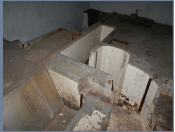
Şekil B: Şlyfer makinasının teksif eleklerine gönderilmeden önceki haznesi ve kanallarının korunarak gösterge olarak sergilenmesi Kaynak:Çakır arşivi
