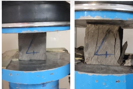
(d) 4. numunenin Basınç dayanımı tayini
