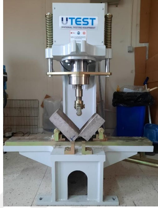
(a) 1. numunenin Eğilme dayanımı tayini
