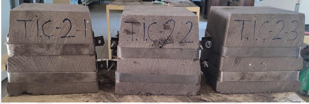
Şekil 4.38. Metal çemberleme uygulaması yapılmış sütun başlığı numuneleri.
