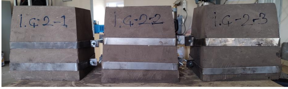
Şekil 4.32. Metal çemberleme uygulaması yapılmış sütun başlığı numuneleri.
