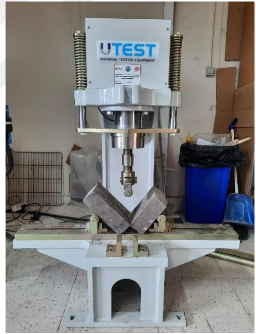
(b) 2. numunenin Eğilme dayanımı tayini
