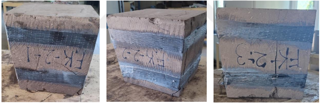
Şekil 4.17. Numunelerin pres makinesinde kırıldıktan sonraki halleri.
