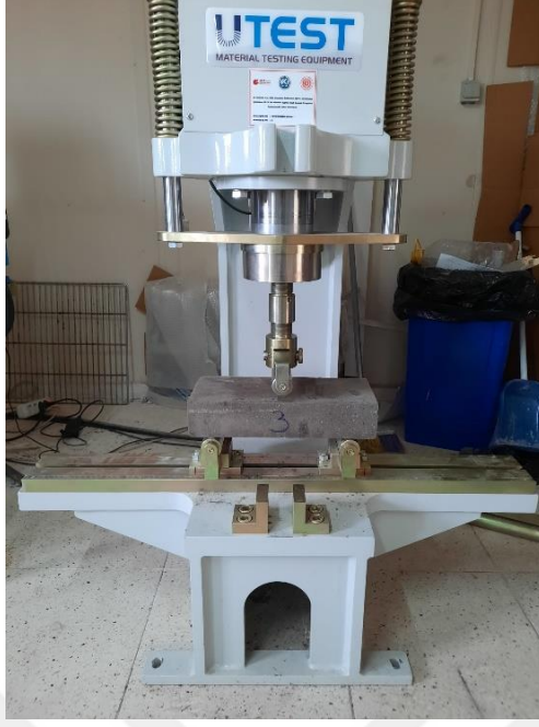
(c) 3. numunenin Eğilme dayanımı tayini
