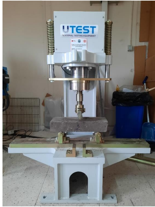
(b) 2. numunenin Eğilme dayanımı tayini
