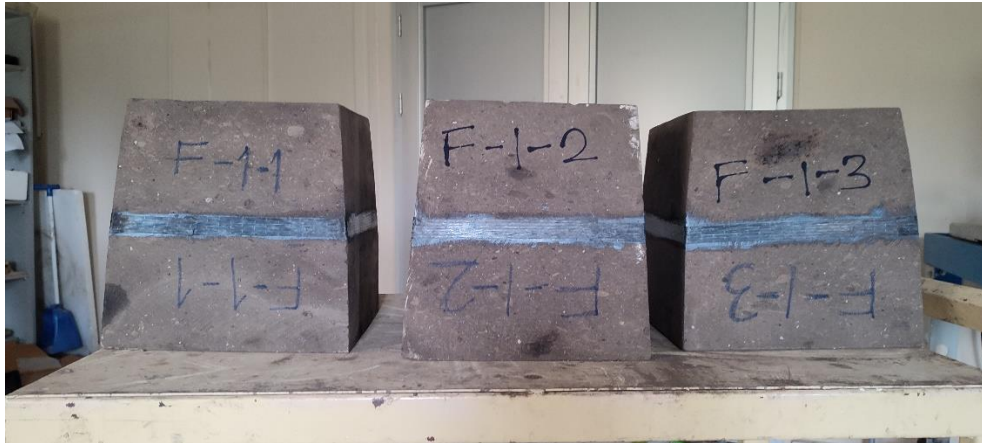
Şekil 4.7. FRP uygulaması yapılmış sütun başlığı numuneleri.
