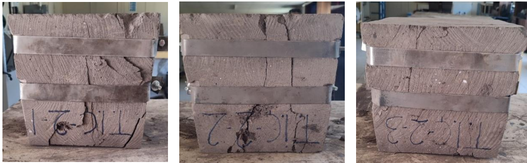
(a) (b) (c) Şekil 4.39. Numunelerin pres makinesinde kırıldıktan sonraki halleri.
