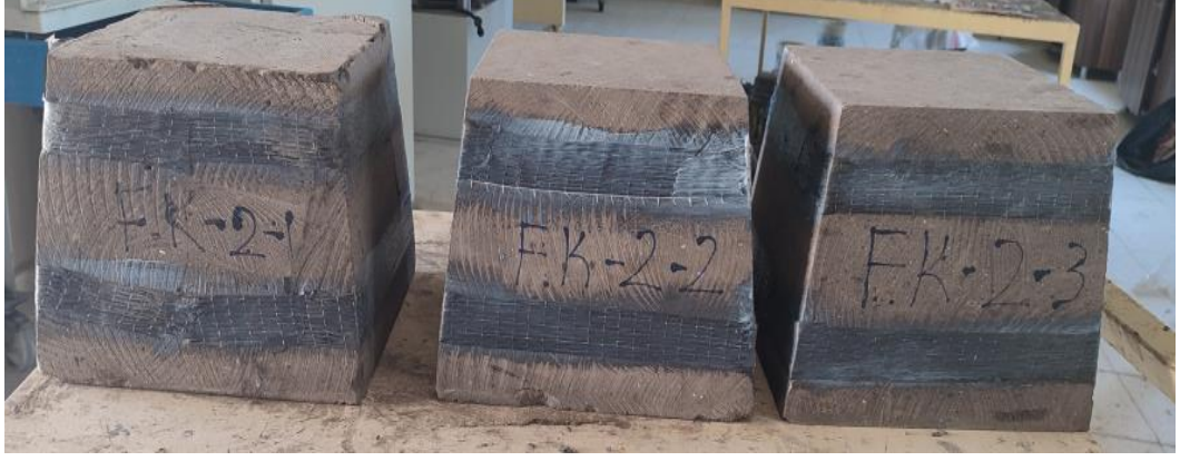
Şekil 4.16. FRP uygulaması yapılmış sütun başlığı numuneleri.
