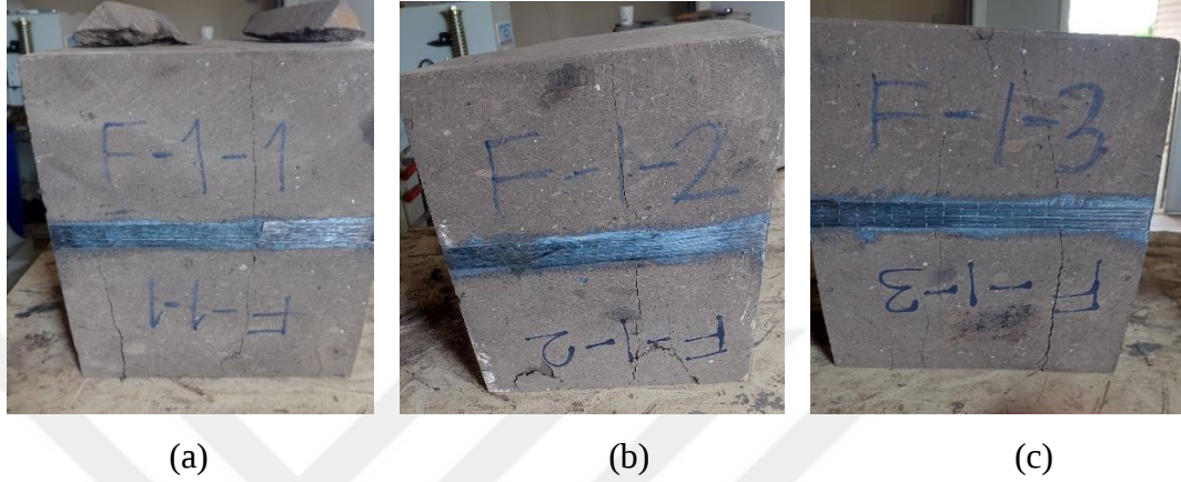
Şekil 4.8. Numunelerin pres makinesinde kırıldıktan sonraki halleri.
