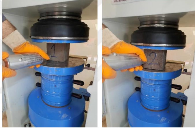
(a) 1. ve 2. numunelerin Schmidt çekici tayini
