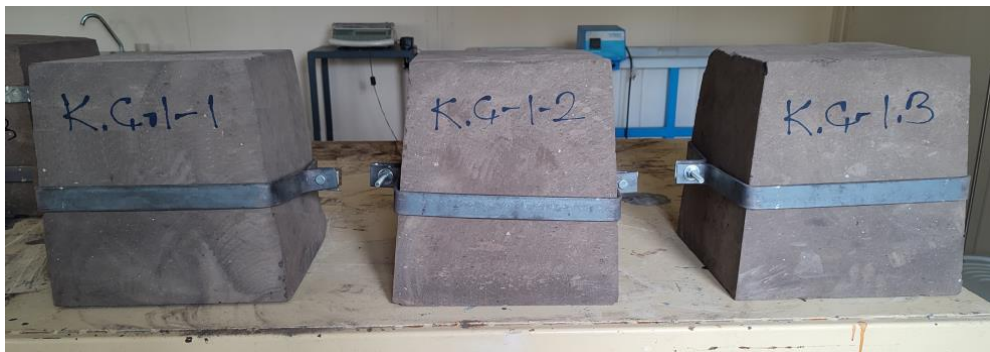
Şekil 4.41. Metal çemberleme uygulaması yapılmış sütun başlığı numuneleri.
