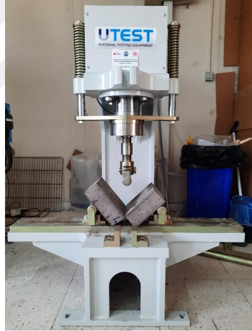
(d) 4. numunenin Eğilme dayanımı tayini
