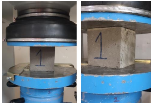
(a) 1. numunenin Basınç dayanımı tayini
