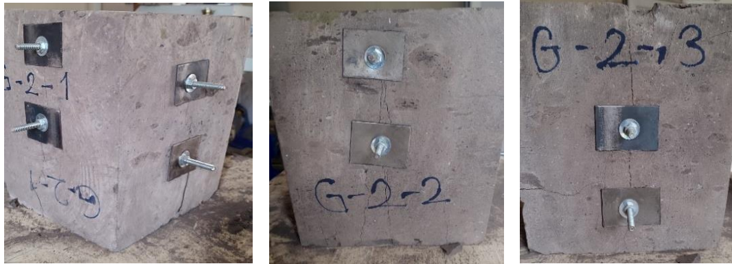
(a) (b) (c) Şekil 4.24. Numunelerin pres makinesinde kırıldıktan sonraki halleri.
