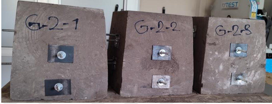
Şekil 4.23. Gijon uygulaması yapılmış sütun başlığı numuneleri.
