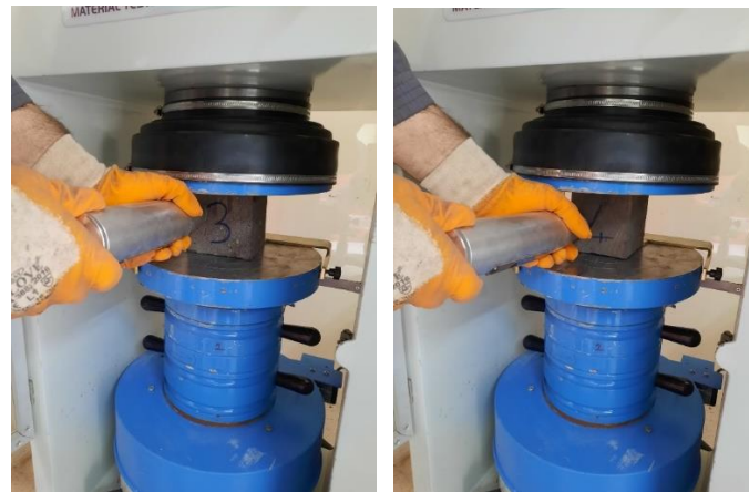
(b) 3. ve 4. numunelerin Schmidt çekici tayini Şekil 3.3 Schmidt çekici deney düzeneği.
