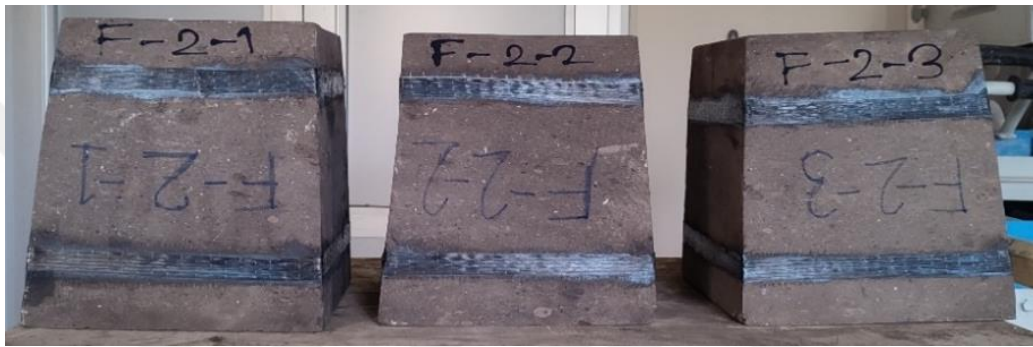
Şekil 4.10. FRP uygulaması yapılmış sütun başlığı numuneleri.
