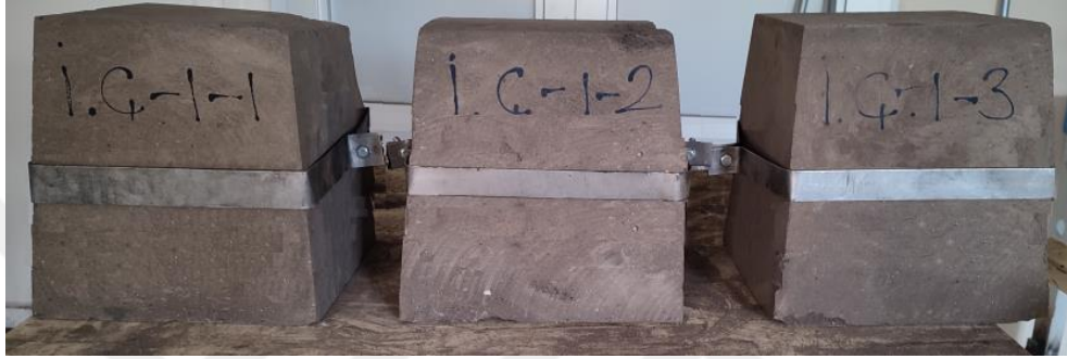
Şekil 4.29. Metal çemberleme uygulaması yapılmış sütun başlığı numuneleri.
