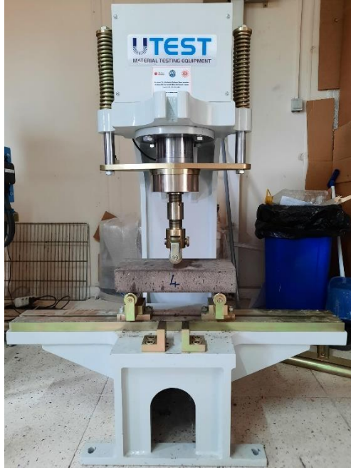
(d) 4. numunenin Eğilme dayanımı tayini
