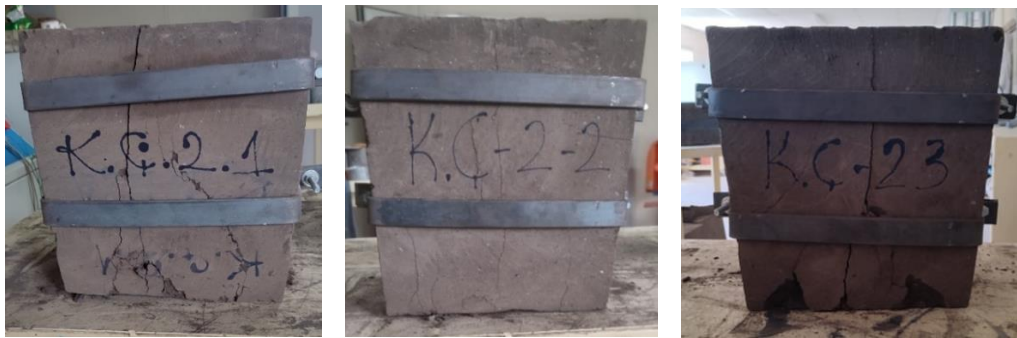
Şekil 4.45. Numunelerin pres makinesinde kırıldıktan sonraki halleri.
