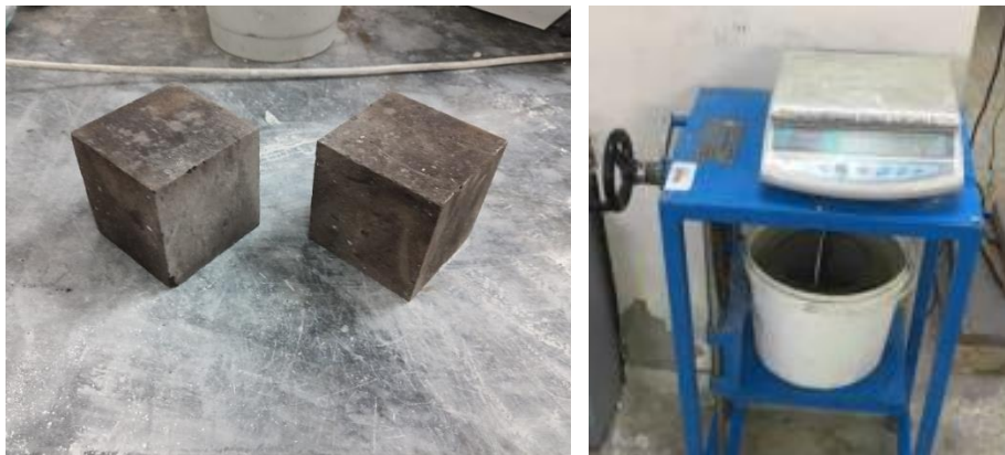
Şekil 3.4. Numunelerin Arşimet terazisi ile tartılması.
