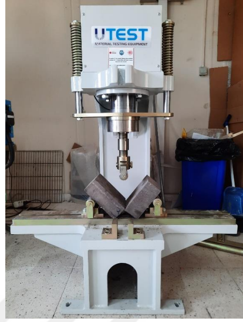
(c) 3. numunenin Eğilme dayanımı tayini
