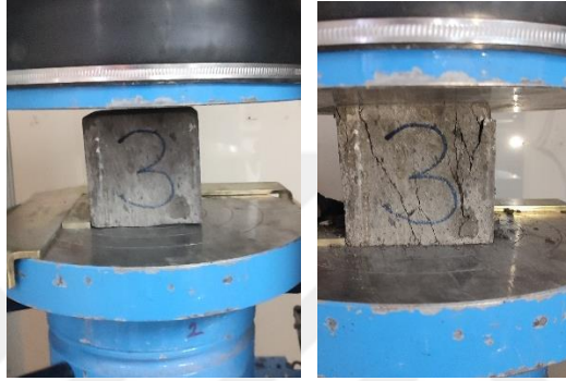
(c) 3. numunenin Basınç dayanımı tayini
