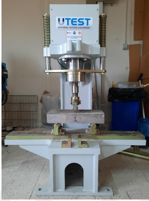
(a) 1. numunenin Eğilme dayanımı tayini
