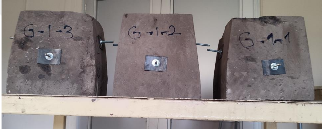
Şekil 4.20. Gijon uygulaması yapılmış sütun başlığı numuneleri.
