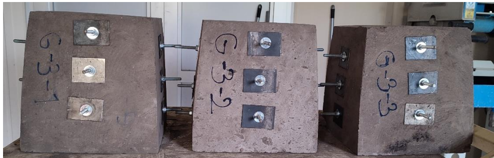
Şekil 4.26. Gijon uygulaması yapılmış sütun başlığı numuneleri.
