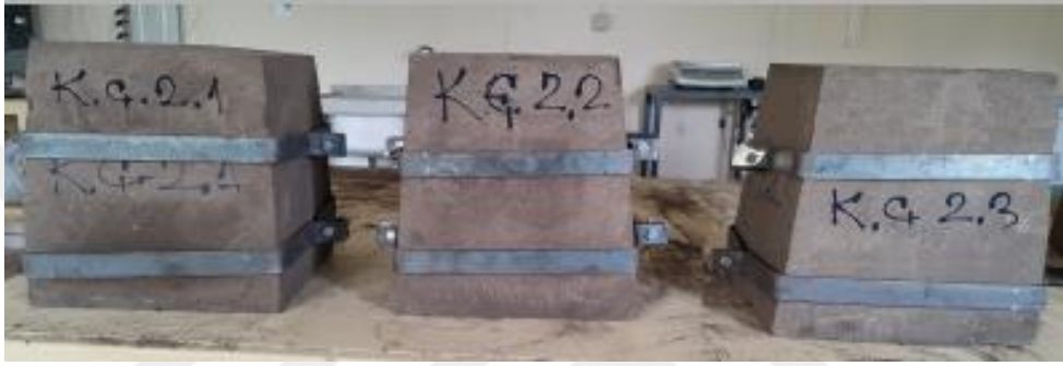
Şekil 4.44. Metal çemberleme uygulaması yapılmış sütun başlığı numuneleri.
