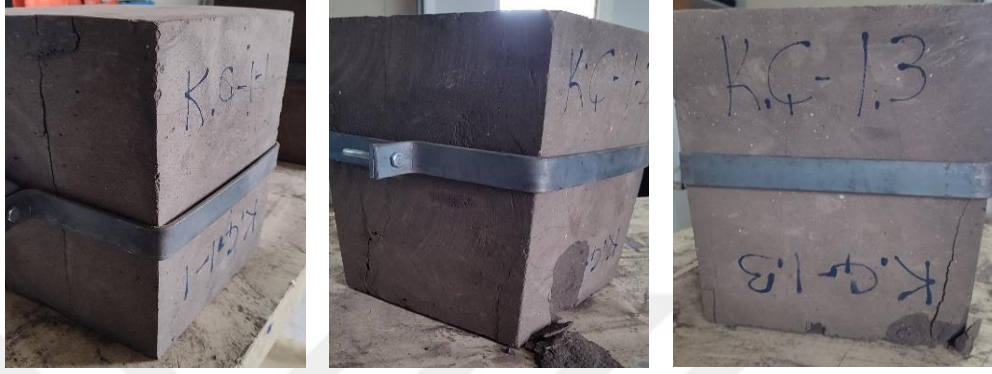
Şekil 4.42. Numunelerin pres makinesinde kırıldıktan sonraki halleri.
