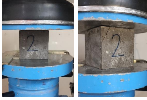
(b) 2. numunenin Basınç dayanımı tayini
