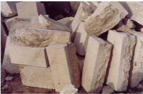
Şekil 7.28 İşlenmiş taşların istiflenmesi ve montajı
