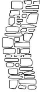
Şekil 7.9 Duvarda oluşabilecek kamburlaşma
