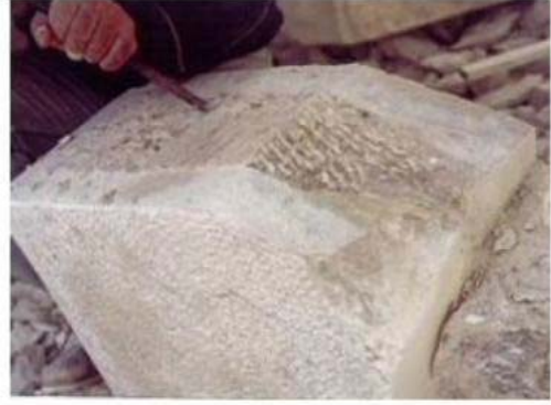
Şekil 7.27 Taş ocağından kütleler halinde getirilen taşların işlenmesi
