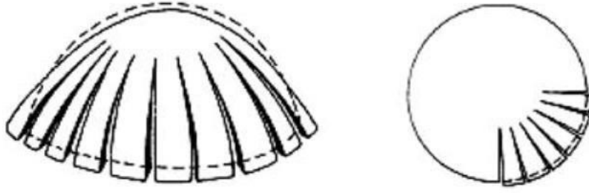
Şekil 6.10 Kubbede tipik hasar biçimleri
