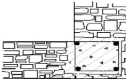
Şekil 7.13 Duvarda kolon oluşturulması
