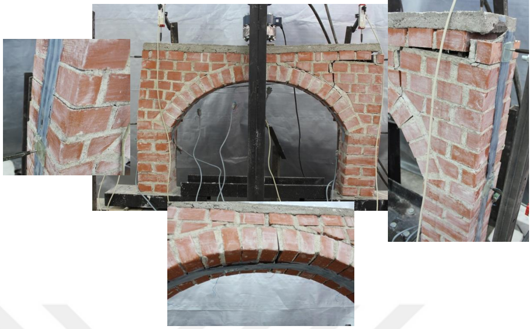
Şekil 4.11. Model-2 yükleme sonrası hali.
