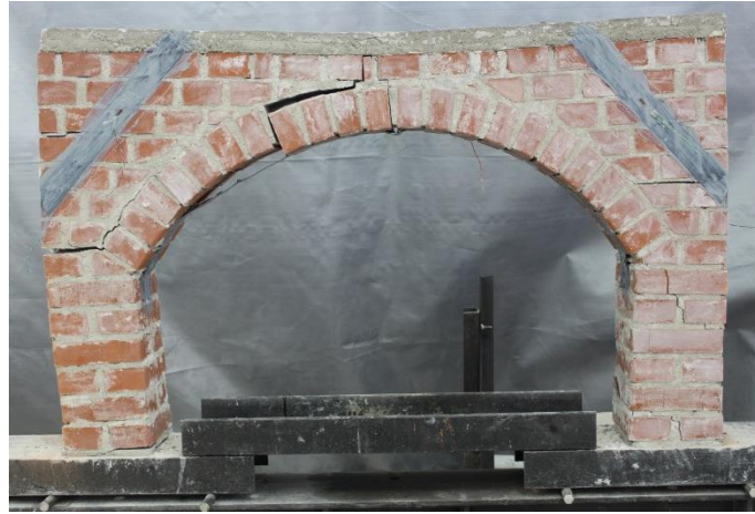
Şekil 4.19. Model-5 yükleme sonrası hali.
