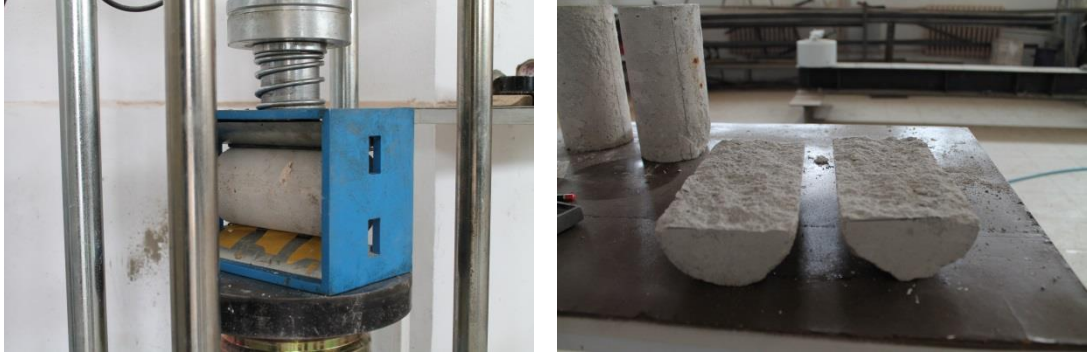
Şekil 3.2. Harcın çekme dayanımı testi.
