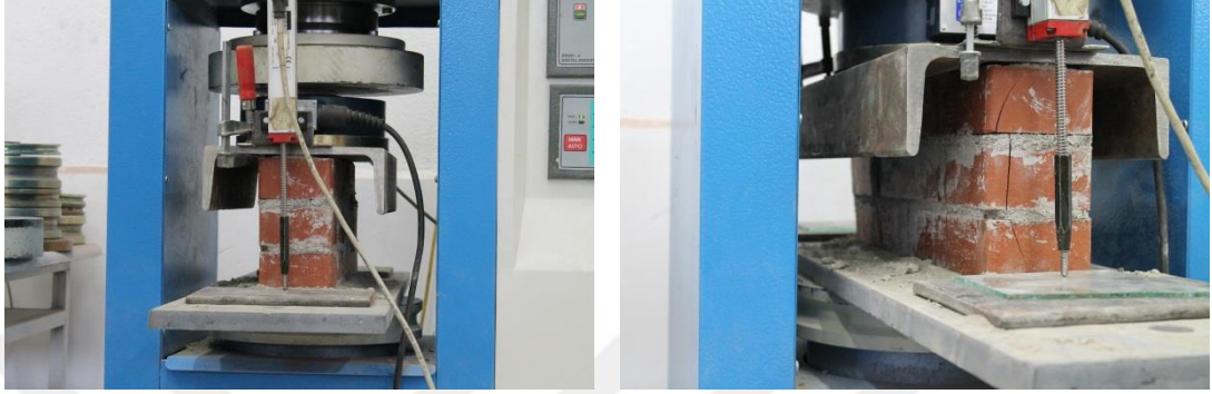
Şekil 3.6. Kagir duvar basınç dayanımı testleri.
