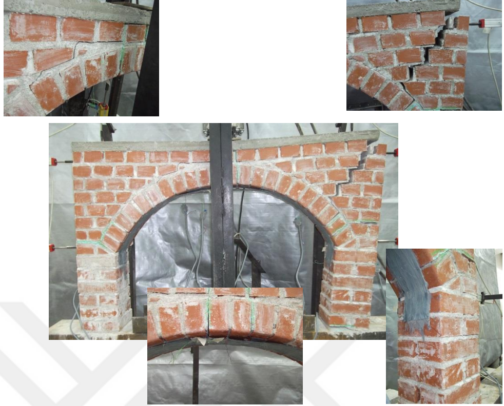
Şekil 4.9. Model-1 yükleme sonrası hali.
