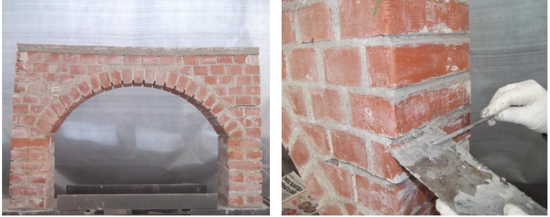
Şekil 4.16. Derzlerin epoksi harcı ile doldurulması.
