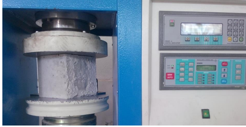
Şekil 3.1. Harcın basınç dayanımı testi.
