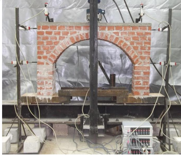
Şekil 4.5. Referans numune yükleme öncesi hali.
