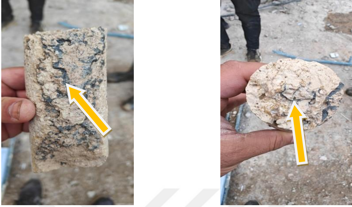
Şekil 4.39. Temel sondaj kuyularından alınan karot fotoğrafları
