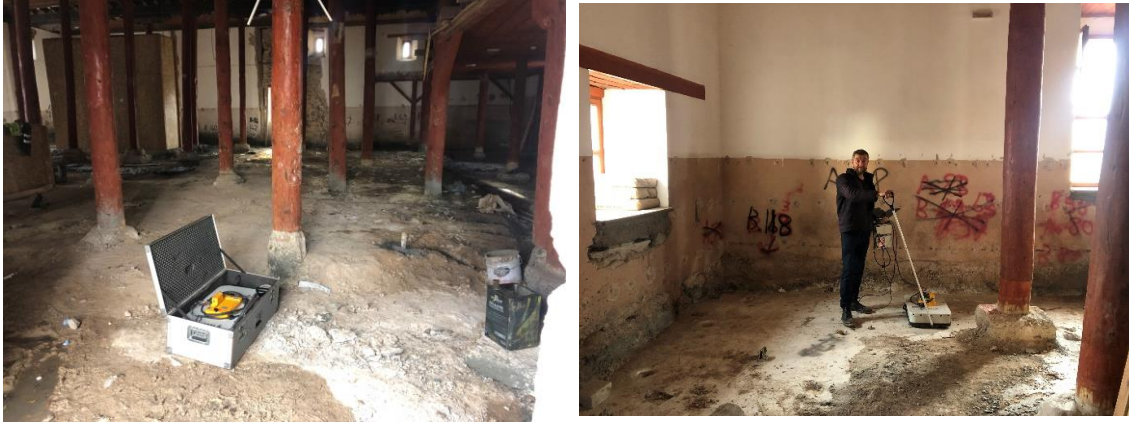
Şekil 4.50. Enjeksiyon sonrasına ait GPR ölçüm fotoğrafları
