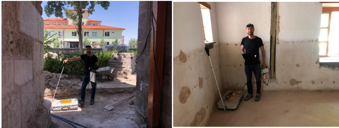
Şekil 4.49. Enjeksiyon öncesine ait GPR ölçüm fotoğrafları
