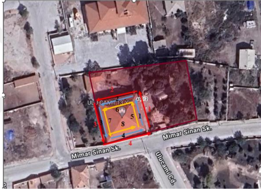
Şekil 4.51. Enjeksiyon öncesine ait Yer Radarı ölçüm profilleri
