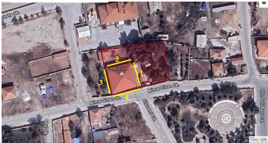
Şekil 4.41. Enjeksiyon uygulaması öncesi MASW ölçüm profil konumları
