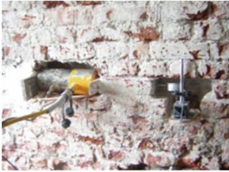
Şekil 3.28. Yerinde kayma deneyi (Öztürk ve Mahberel 2006)
