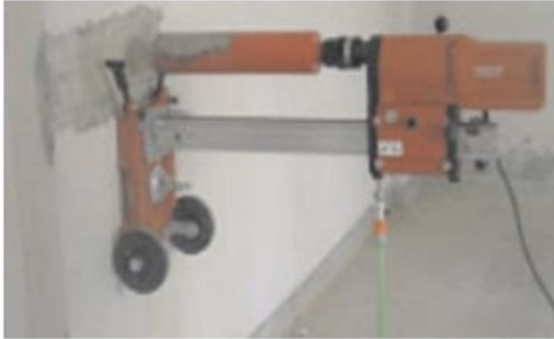
Şekil 3.29. Karot makinesi ve numune alımı - Karot numunesi
