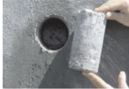
Şekil 3.29. Karot makinesi ve numune alımı - Karot numunesi
