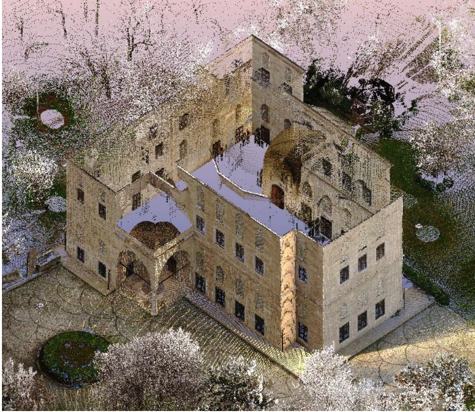
Şekil 5.15 Oluşturulan lazer tabanlı nokta bulutu modelinin 30 kat seyreltilmiş halinin görseli.
