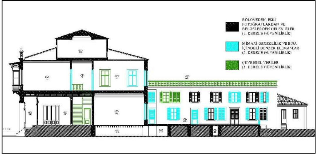
Şekil 2.15 1. Kordon Kendir Yalısı restitüsyon kesiti.
