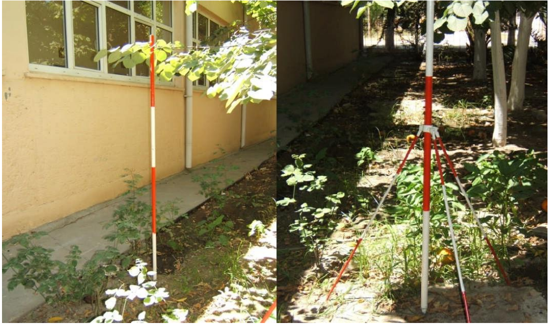
Şekil 3.6 Jalon ve jalon sehpa (Milli Eğitim Bakanlığı [MEB], Uzunluk ölçme, 2011, s.14).
