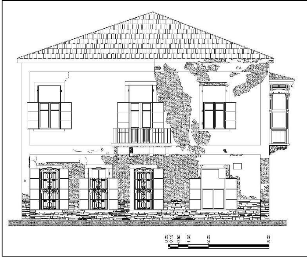
Şekil 5.19 Düzeltilmiş fotoğraf yardımı ile çizilen cephe rölövesi.
