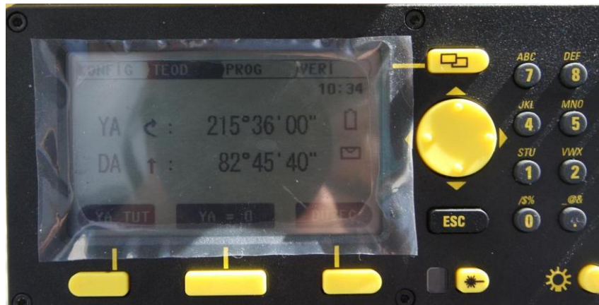
Şekil 4.16 Yatay düzlemin sıfırlanması ve ölçüm modunun seçiminin yapılması.
