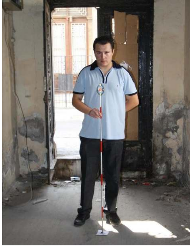
Şekil 4.21 Prizma ile reflektörlü ölçüm yapılması.
