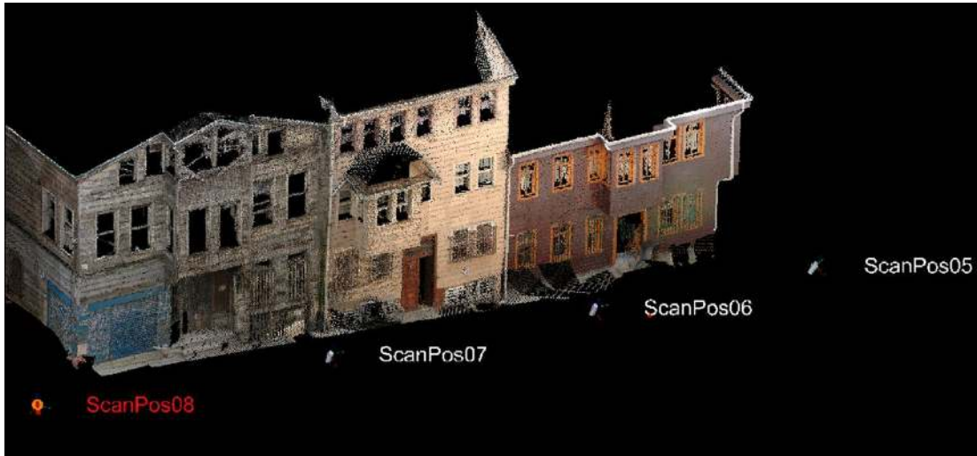
Şekil 4.35 Farklı istasyon noktalarında taranan nokta bulutlarının birleştirilmesi (3D lazer tarama, (b.t). 2012, www.semaproje.com.tr ).
