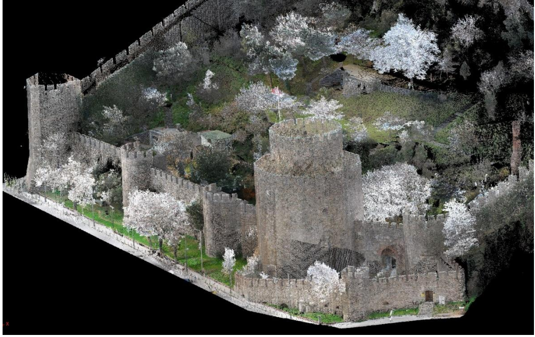
Şekil 4.34 Lazer tarama sonucu elde edilen renkli nokta bulutu (3D lazer tarama, (b.t). 2012, www.semaproje.com.tr ).
