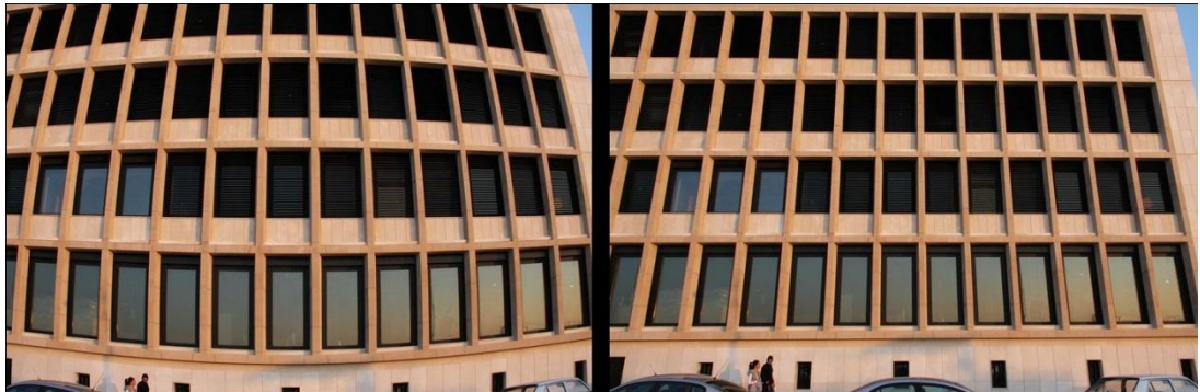
Şekil 5.3 Fotoğraf makinesinden kaynaklanan radyal distorsiyon ve distorsiyonun giderilmiş görüntüsü.
