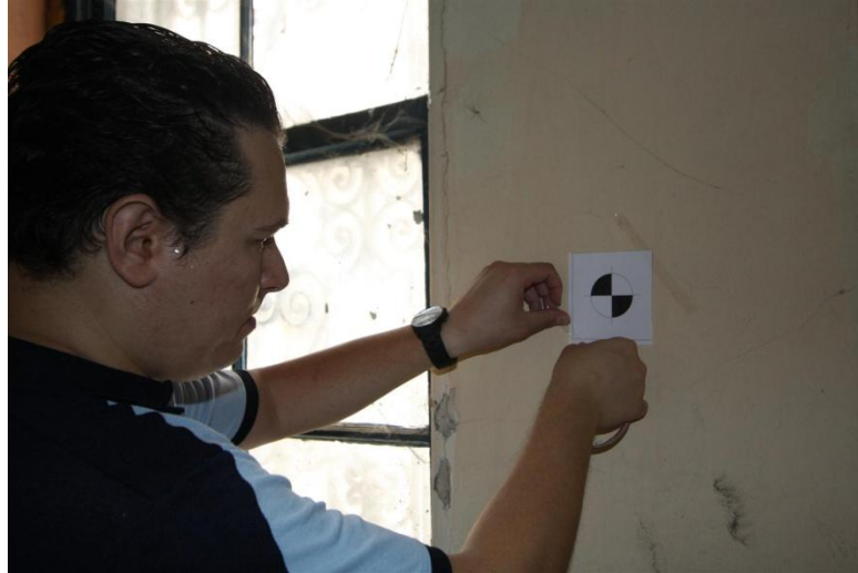
Şekil 4.18 Kontrol noktalarının duvara tatbik edilmesi işlemi.
