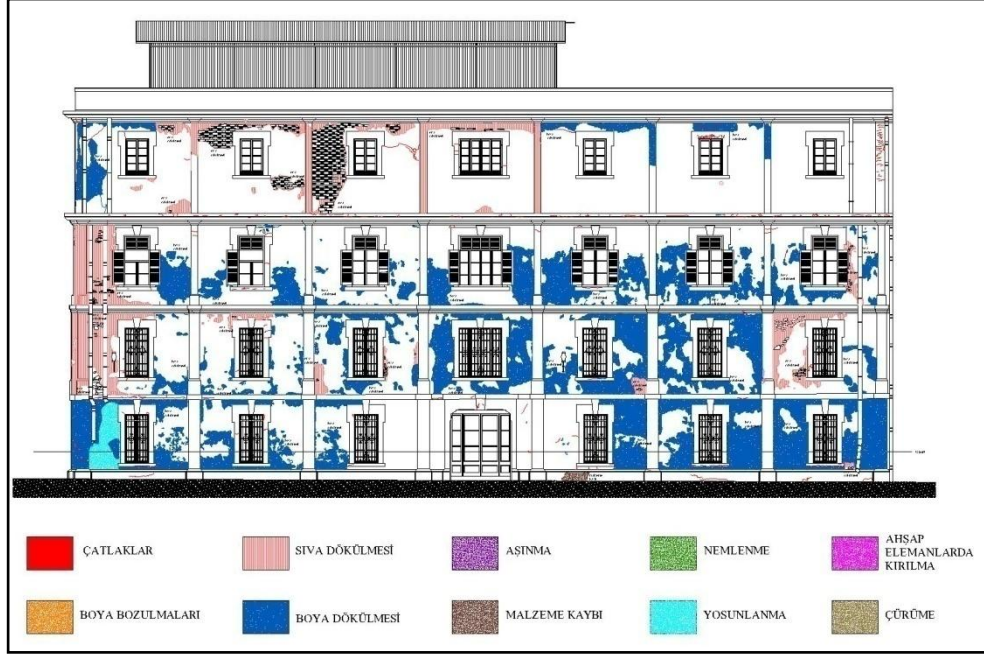
Şekil 2.10 Alsancak Tekel Deposu güney cephe rölovesinin malzeme analizi.
