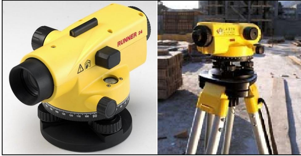
Şekil 4.4 Kompansatörlü Nivo (Nivolar, (b.t). 2012, www.totalstationnivo.com ).
