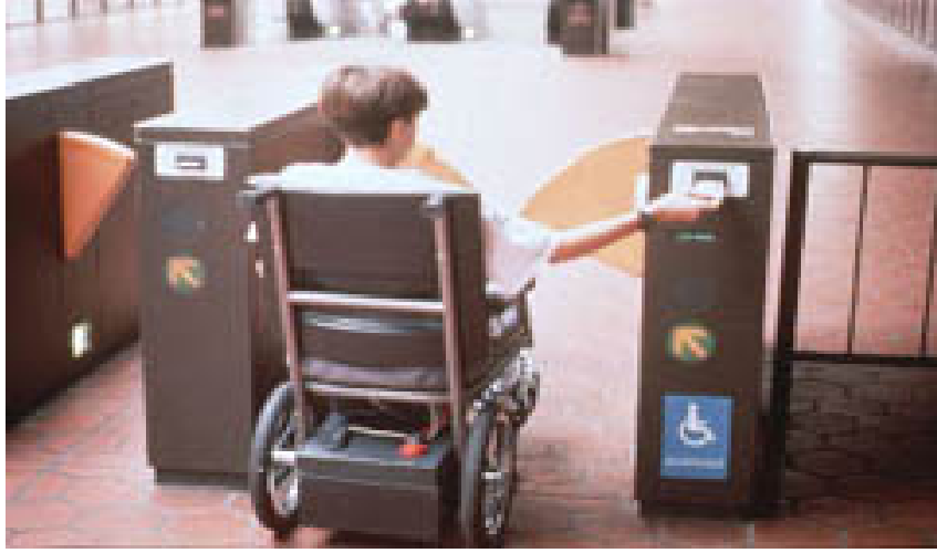
Şekil 2.8 Otomatik geçiş, elektrikli tekerlekli sandalye kullanan bir kişiye de uygundur.
