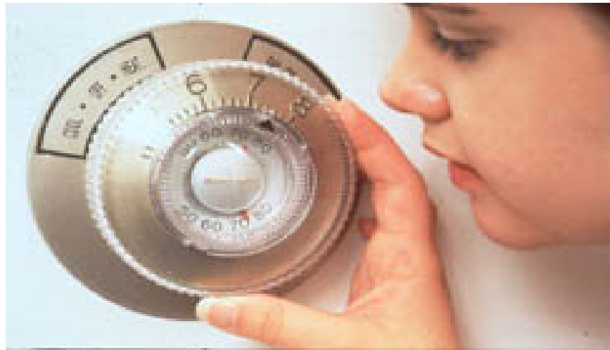
Şekil 2.5 Az gören bir kişi için yakın mesafeden dokunsal göstergeli ve sesli bir termostat.
