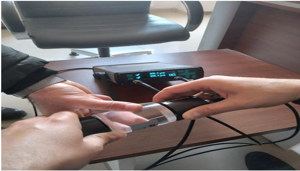
Şekil 5.2: Ultrasonik Ses Testi cihazının kalibre edilmesi.
