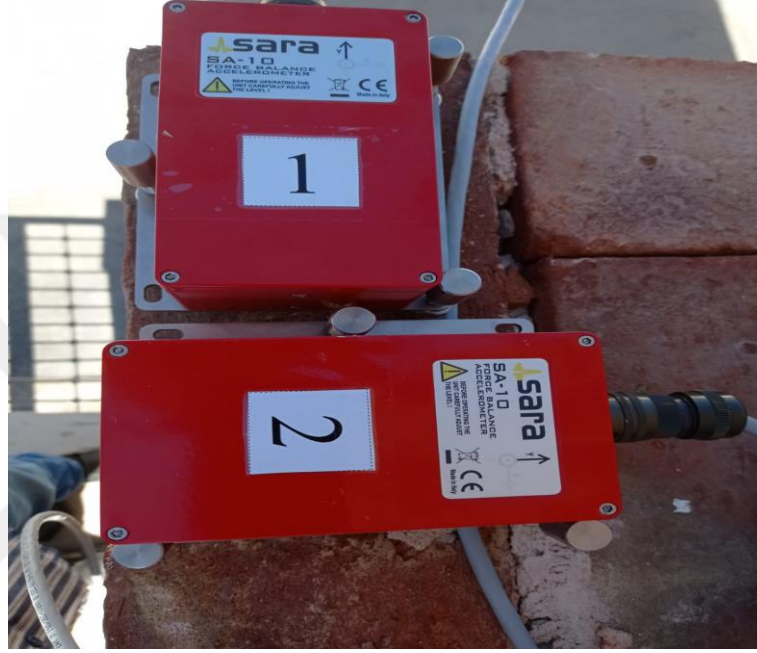
Şekil 4.1: İvmeölçerlerin kaide köşelerine yerleştirilmesi.
