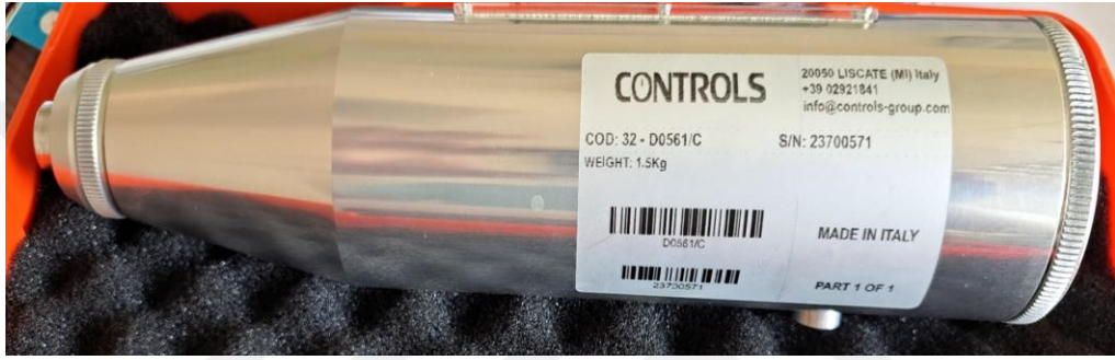
Şekil 5.1: Kayaçlar için kullanılan L tipi Schmidt çekici.
