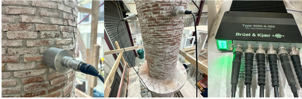
Şekil 16. İvmeölçer sensörlerinin minyatür minare modeli üzerindeki yerleşimi
