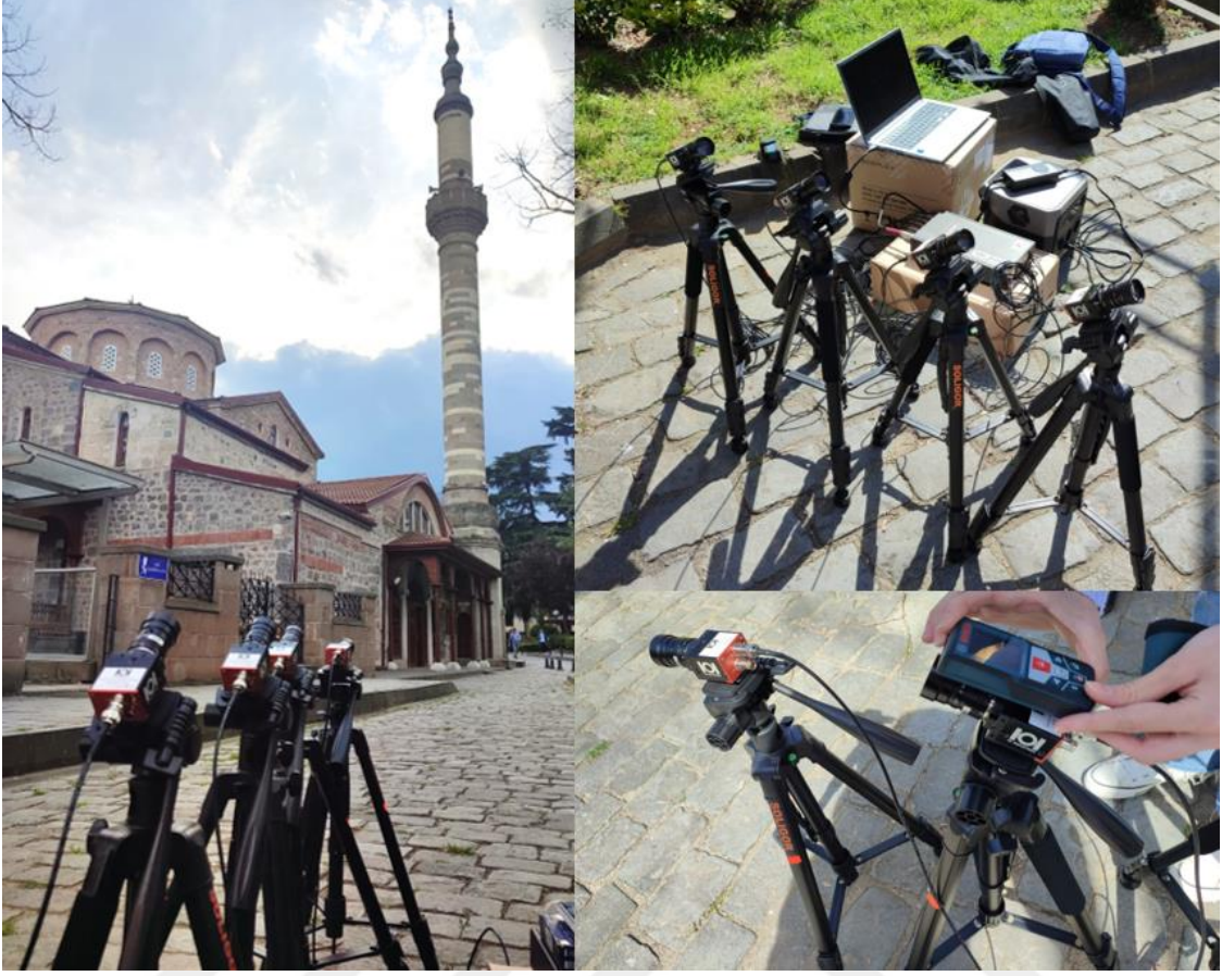
Şekil 28. Fatih Büyük Cami minaresi ölçümü; kamera sistemi konumlandırılması ve ölçüm detayları
