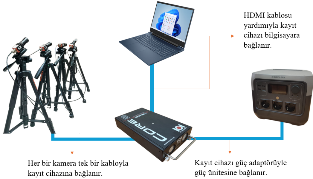
Şekil 2. Video kamera tabanlı izleme sistemi; donanım bağlantı şeması
