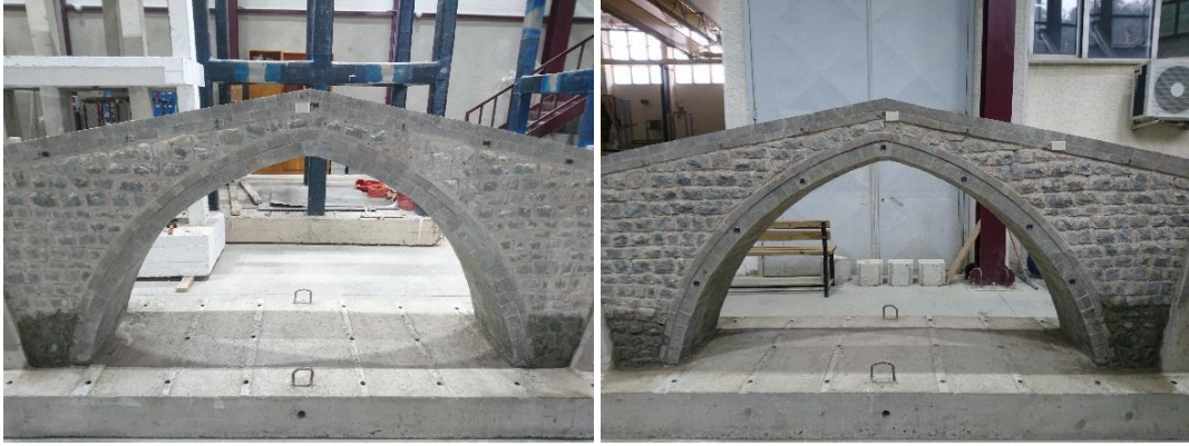
Şekil 2.90. Malzeme boşalması hasarının tamamlama yapılarak onarılması
