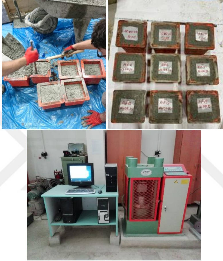
Şekil 2.68. Beton numunelerinin alınması ve basınç deneyine ait fotoğraflar
