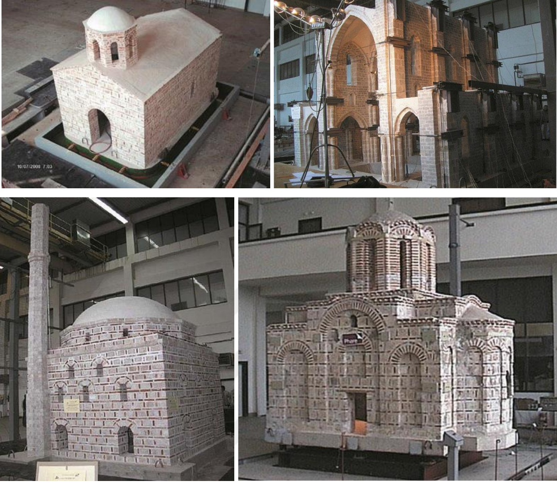
Makedonya, Üsküp'te yer alan IZIIS laboratuvarında inşa edilen ölçekli tarihi yapı modelleri (Shendova vd., 2012).
