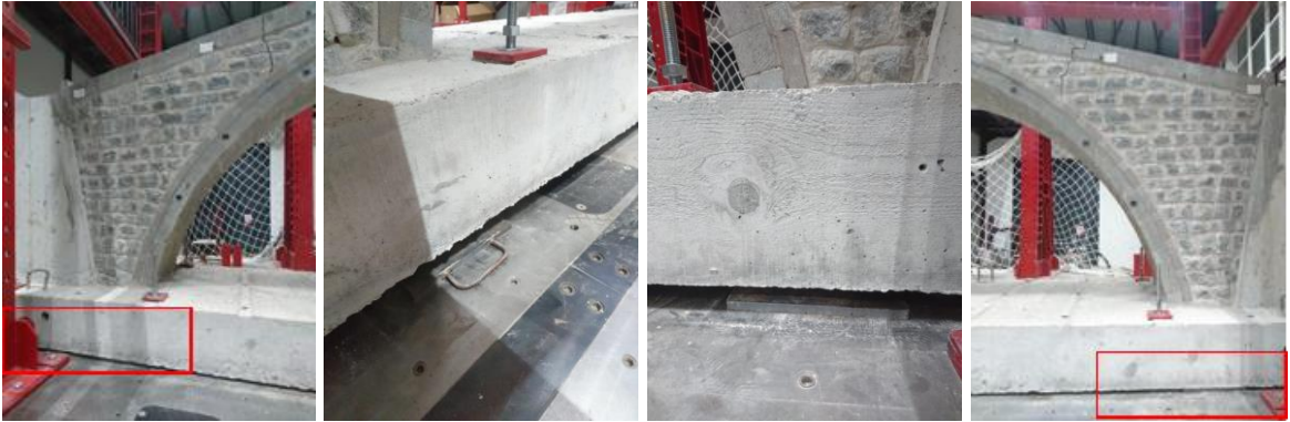
Şekil 2.77. Mesnet çökmesi hasarı için köprünün ayaklarına yerleştirilen çelik levhalar
