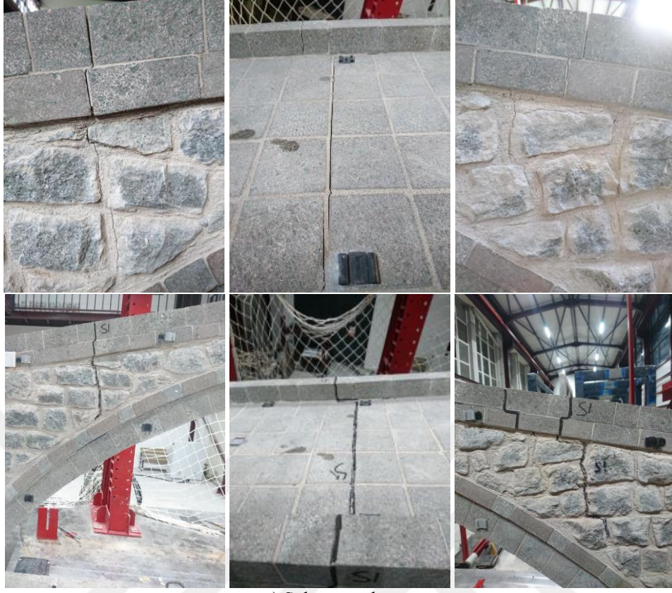
a) Sol mesnet hasarı
