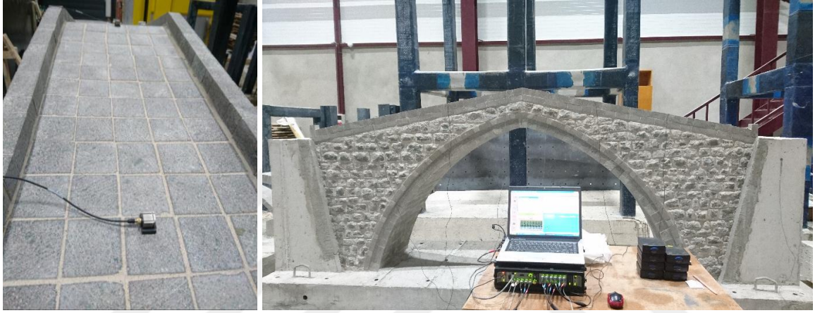
Şekil 2.73. Deneysel Modal Analiz testlerine ait görünüşler
