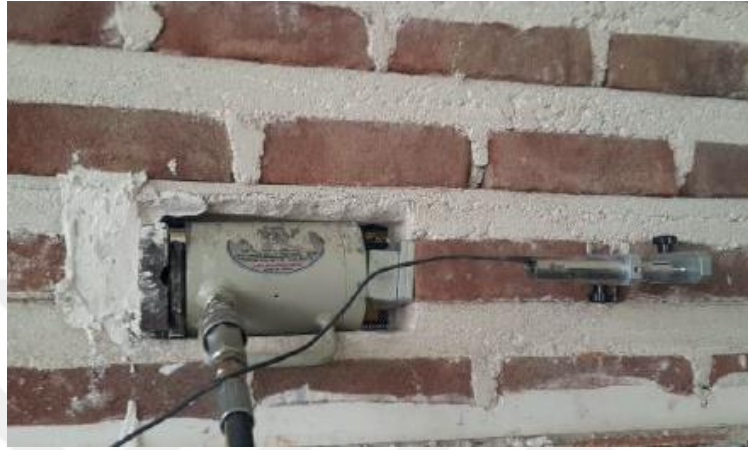
Şekil 1.47. Yerinde kayma deneyi uygulaması (Yüzer vd., 2015).
