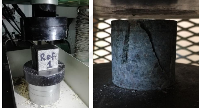
Şekil 2.67. Andezit ve bazalt taşların basınç deneylerine ait görünüşler
