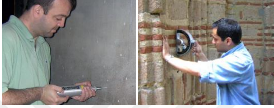
Şekil 1.44. Doğal taşlarda ve yığma duvarlarda N ve P tipi çekiçlerle yüzey sertliği ölçümü (Özturan vd, 2006; Krstevska vd, 2007).
