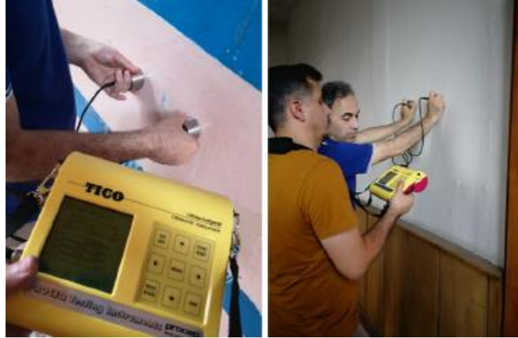
Şekil 1.43. Yığma duvar üzerinde ultrases ölçümü (Günaydin vd., 2022).
