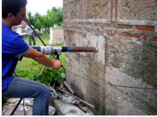
Şekil 1.49. Yapıdan numune (karot) alınması (Krstevska vd, 2007).
