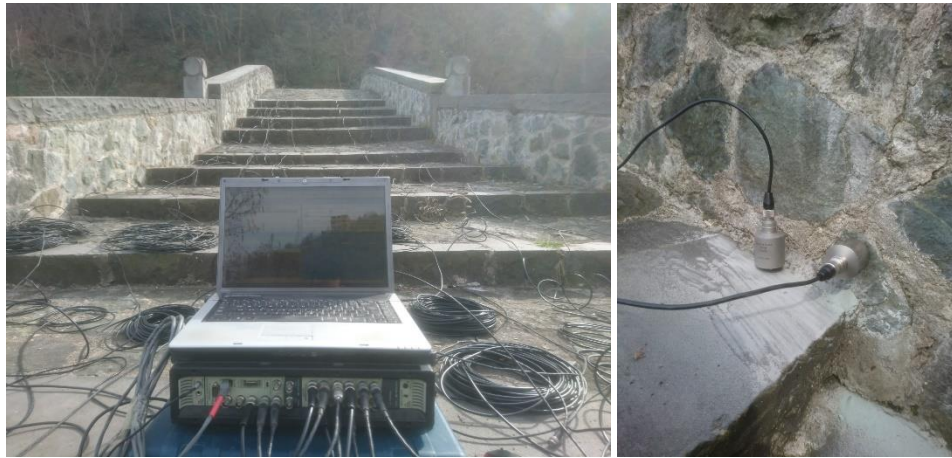
Şekil 2.59. Ortam titreşim testinde kullanılan ivmeölçer düzeni ve bağlantı görünüşü
