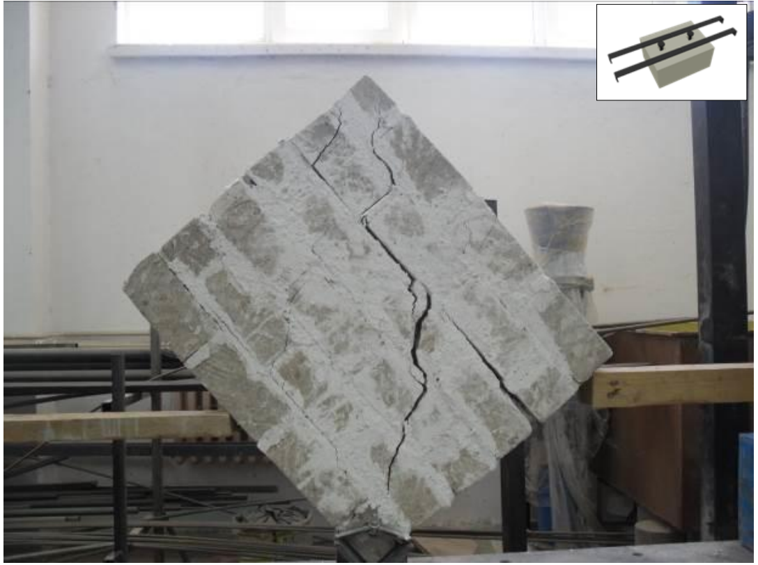
Şekil 4.45. M61 duvar numunesinin deney sonucu görüntüsü
