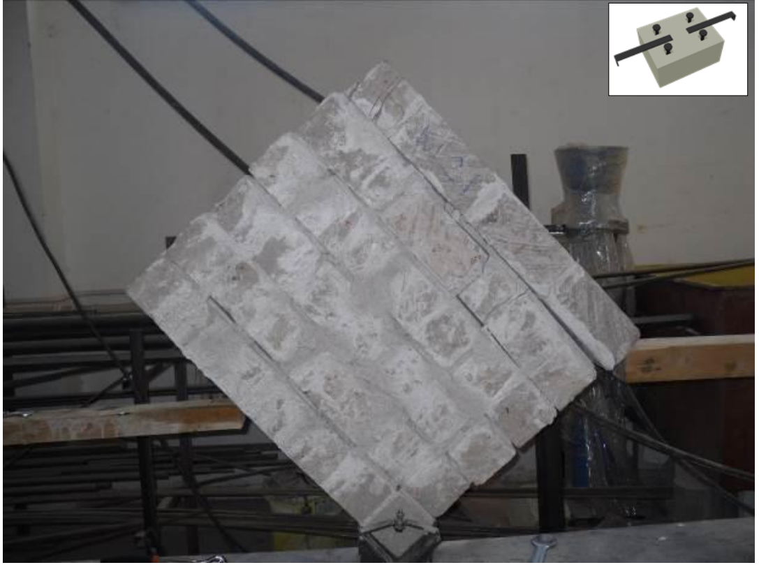
Şekil 4.13. M21 duvar numunesinin deney sonucu görüntüsü
