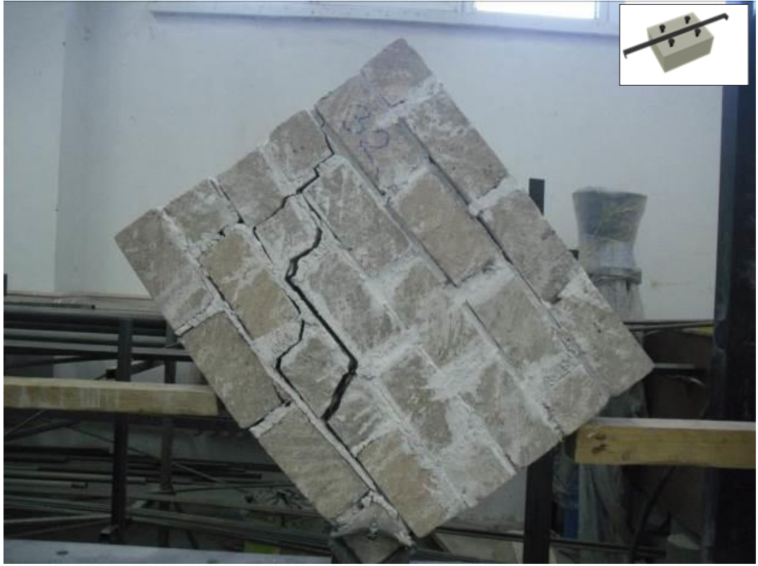
Şekil 4.25. M32 duvar numunesinin deney sonucu görüntüsü
