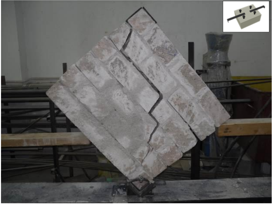
Şekil 4.17. M22 duvar numunesinin deney sonucu görüntüsü
