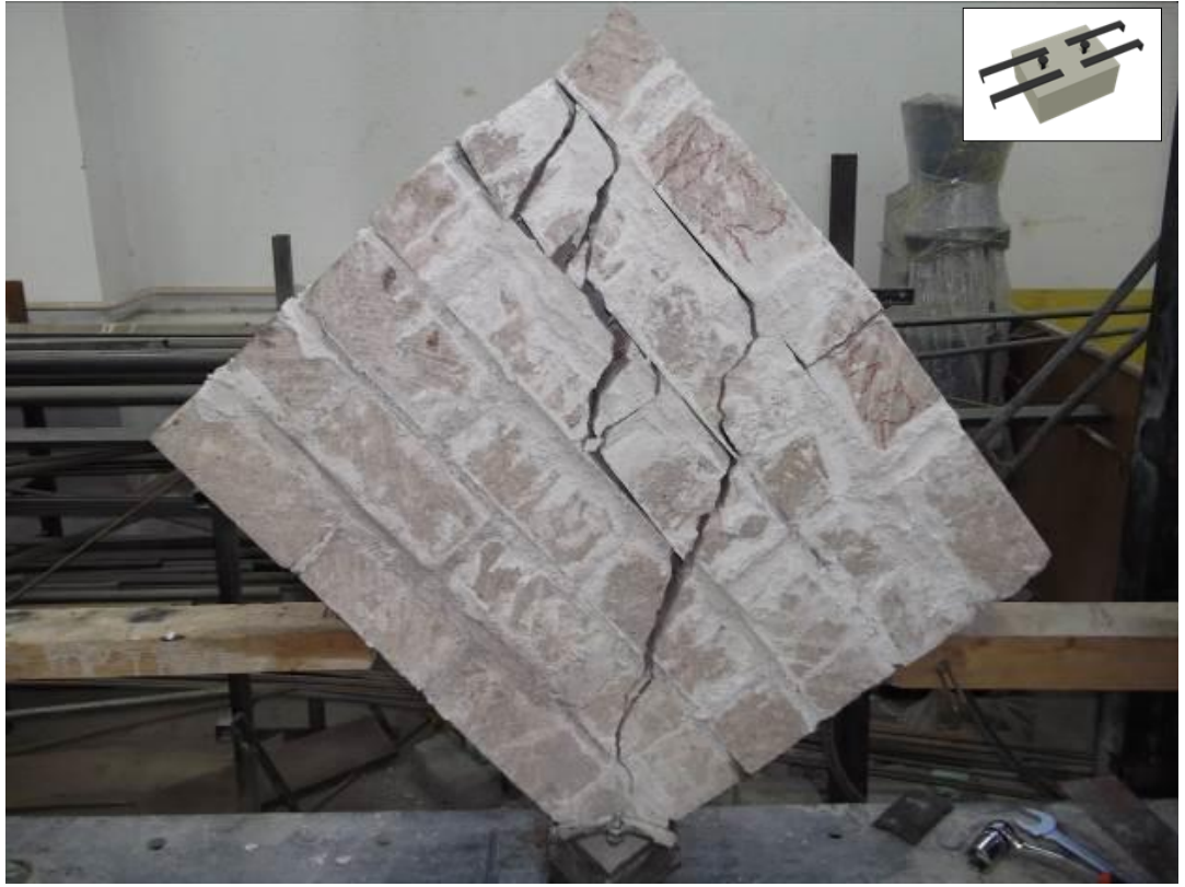
Şekil 4.41. M52 duvar numunesinin deney sonucu görüntüsü
