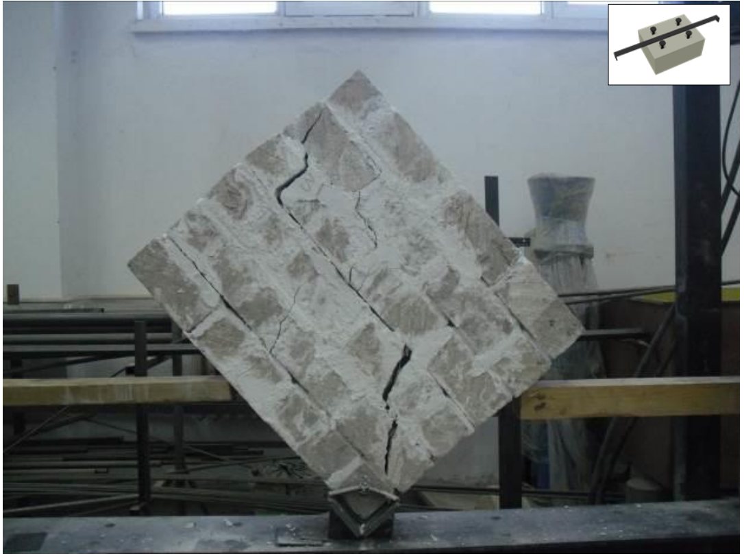
Şekil 4.21. M31 duvar numunesinin deney sonucu görüntüsü
