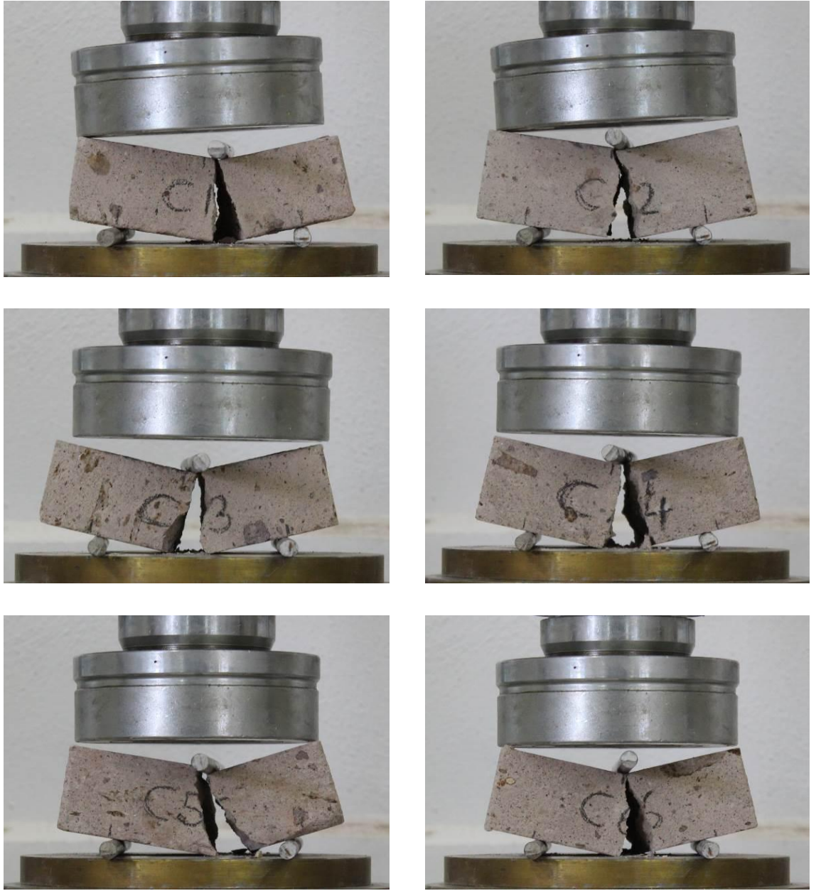
Şekil 3.5. Yığma birimlerin eğilmede çekme dayanımı testleri (C1-C6 numuneleri)
