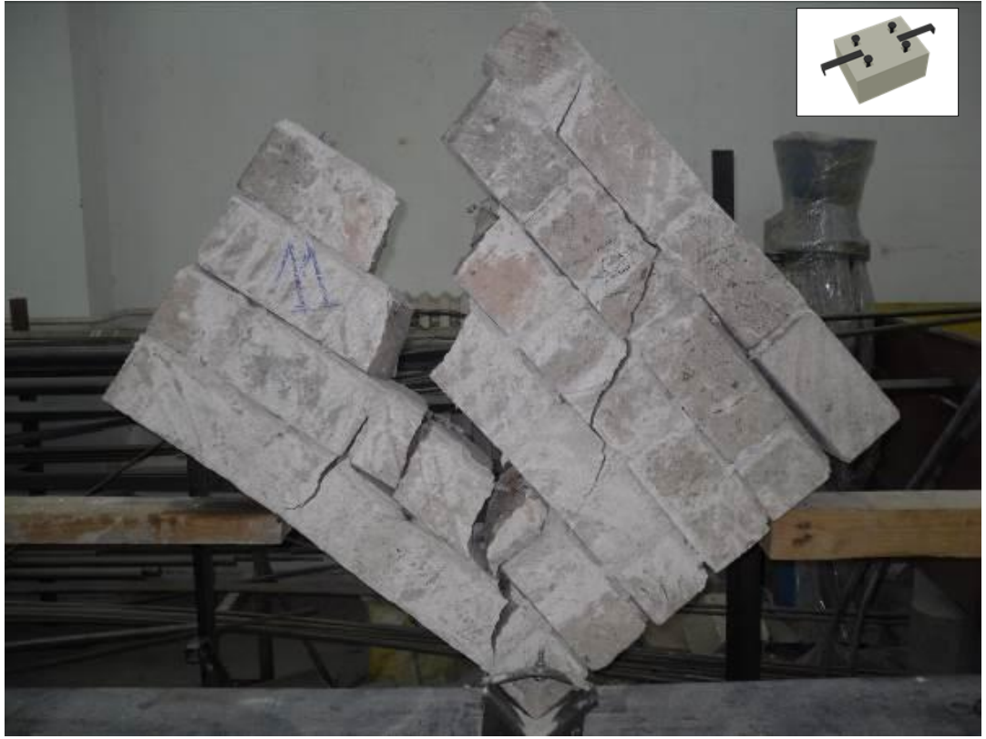
Şekil 4.5. M11 duvar numunesinin deney sonucu görüntüsü
