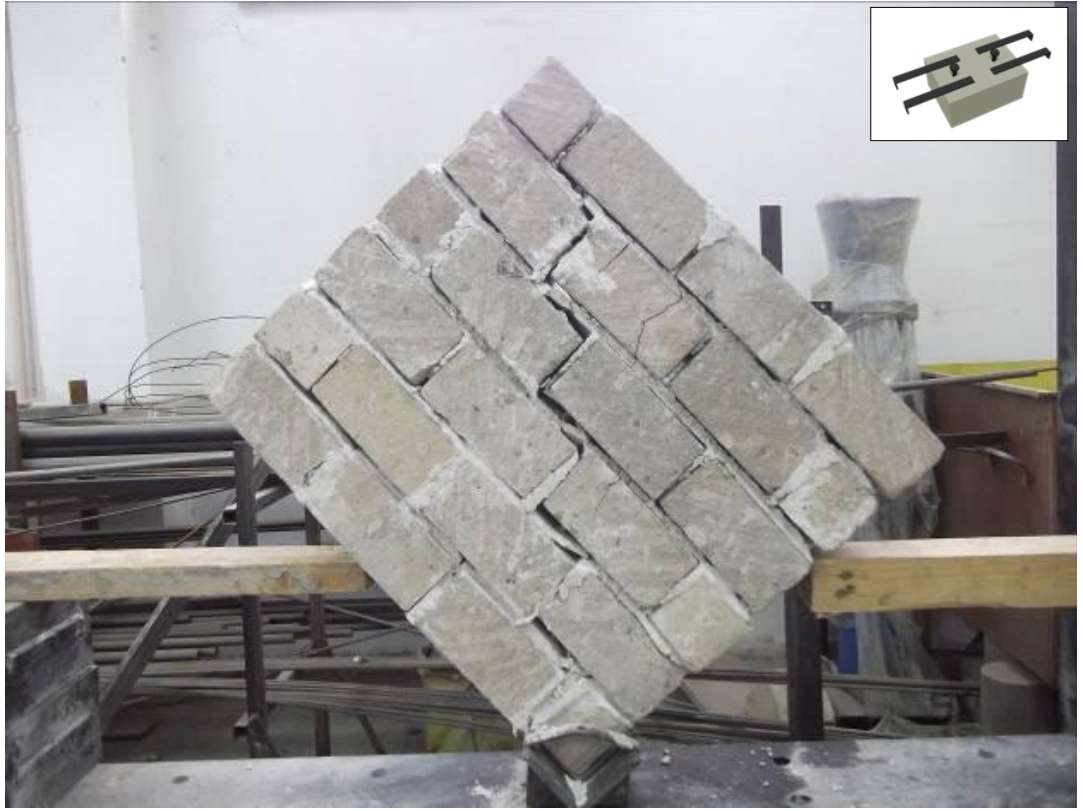
Şekil 4.37. M51 duvar numunesinin deney sonucu görüntüsü
