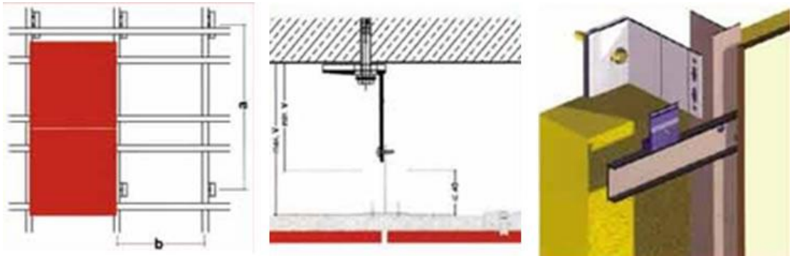
Şekil 3.12 Perçinli sistem (sander katalog, 2012)
