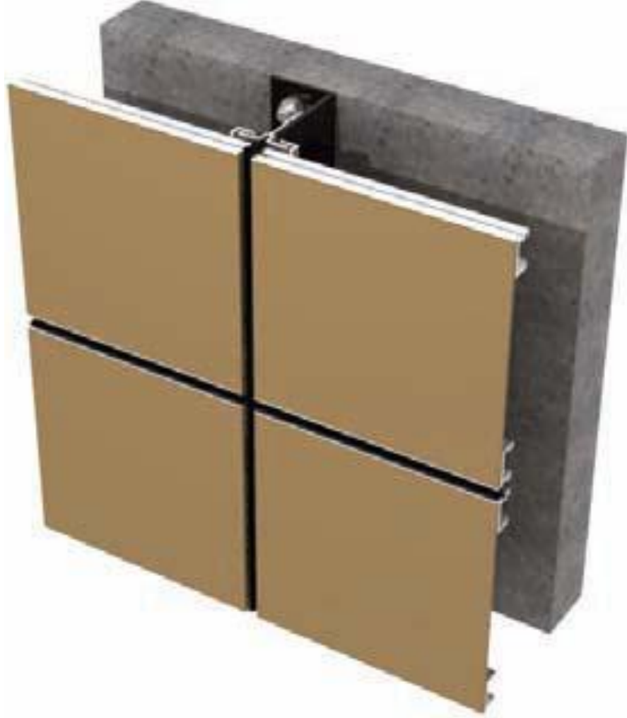
Şekil 3.5 İnce porselen seramik levha Cuhadaroğlu SX sistem montaj detayı ( www.kale.com.tr , 2012)
