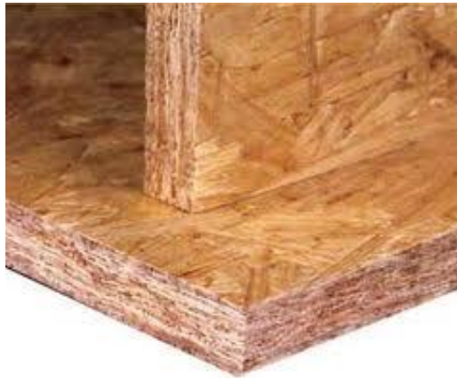
Şekil 3.10 OSB plaka kesit (catimakasi.com,2012)
