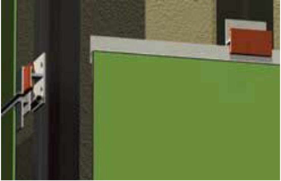
Şekil 3.6 İnce porselen seramik levha Gizli klips sistem montaj detayı ( www.Kale.com.tr,2012)
