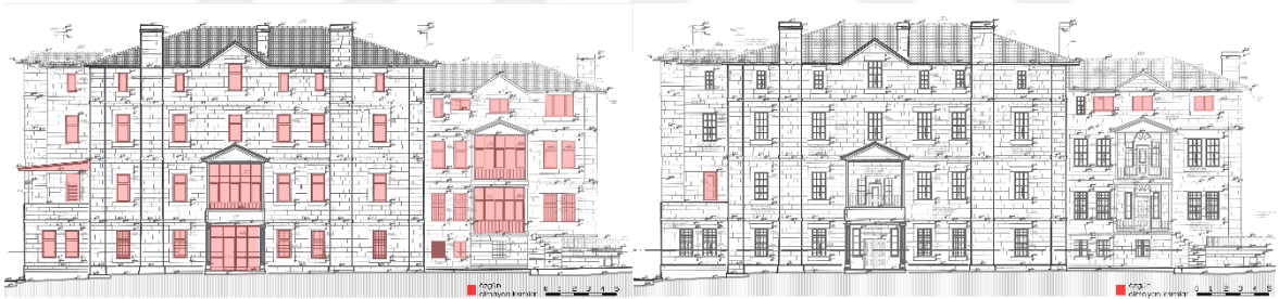
Şekil 3.43. Erkek Okulu Binası batı cephe restorasyon öncesi/sonrası
