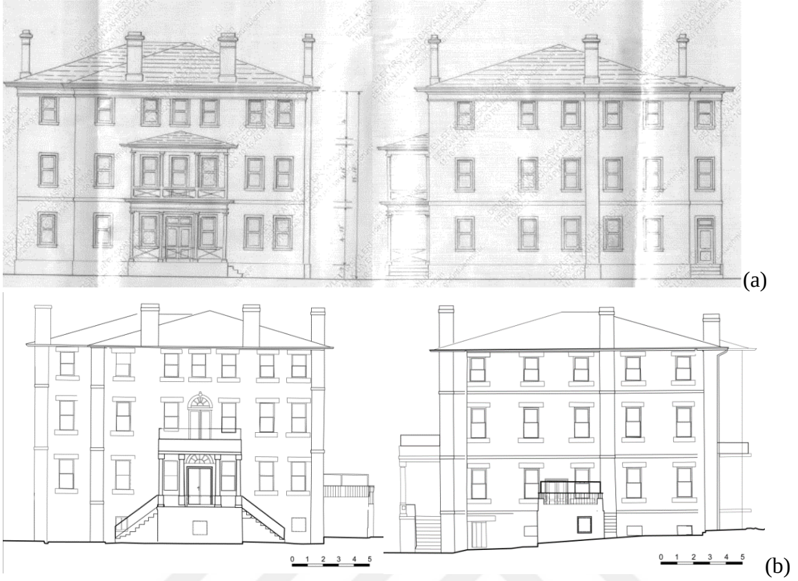
Şekil 3.36. Kız Okulu Ek Binası batı ve güney cepheleri a) Ruhsat izni için çizilen batı ve güney cepheleri 65 b) Batı ve güney cephesi, 2020
