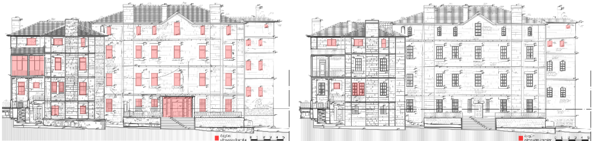
Şekil 3.44. Erkek Okulu Binası batı cephe restorasyon öncesi/sonrası
