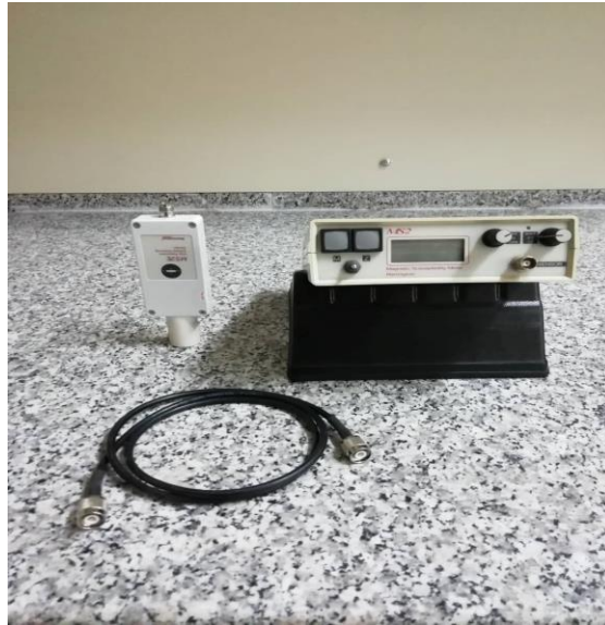
Şekil 4.5 Jeomanyetizma ve Paleomanyetizma Laboratuvarında yer alan MS2 cihazı ve E sensörü (Kişisel arşiv, 2019)
