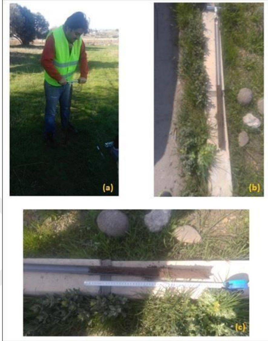
Şekil 5.11 Düşey veri örneklerinin toplanması ve burgu. (a)Karot örneğinin alınması, (b) Burgunun boydan görüntüsü, (c) Burgu ve alınan örneğe ait görüntü (Kişisel arşiv, 2018)
