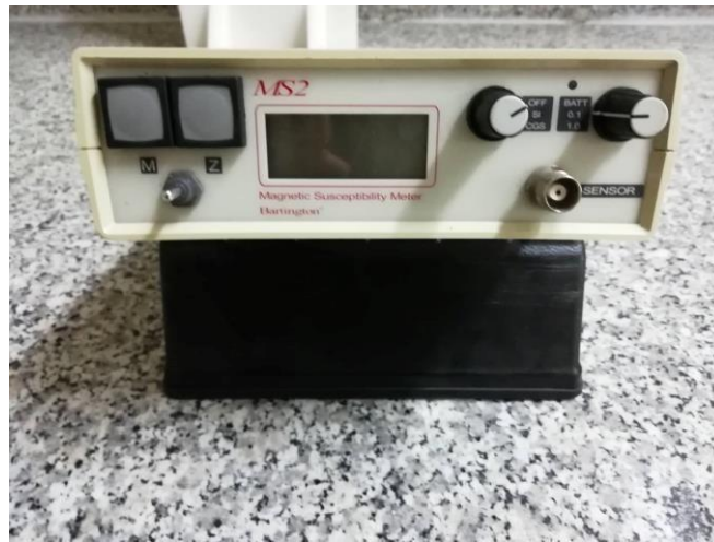
Şekil 4.3 MS2 Metre Manyetik Duyarlılık Sistemi (Kişisel arşiv, 2019)
