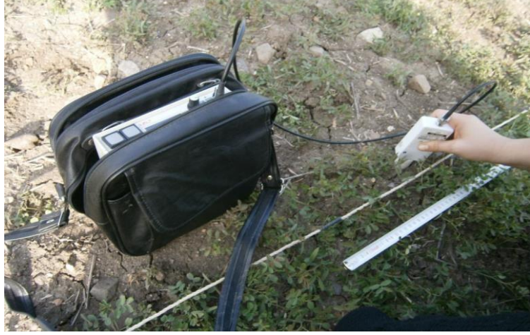
Şekil 5.3 MS2E sensörlü manyetik duyarlılık aleti. Şekilde verilen bu alet arazide kullanılmıştır (Kişisel arşiv, 2016)
