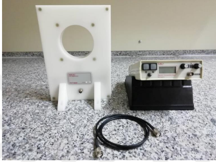
Şekil 4.4 DEÜ Jeomanyetizma ve Paleomanyetizma Laboratuvarında yer alan MS2 cihazı ve C sensörü (Kişisel arşiv, 2019)
