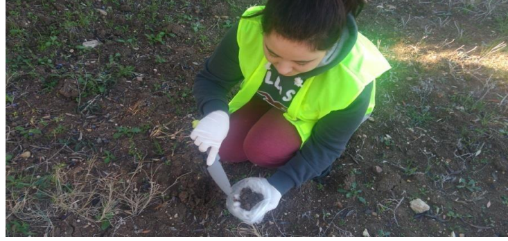
Şekil 5.17 Kimyasal analiz çalışmaları için örneklerin toplanması (Kişisel arşiv, 2018)
