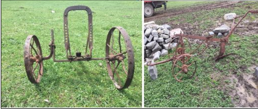
Resim 3.4. Herazan ve herazan eklentili kotan görünümü
