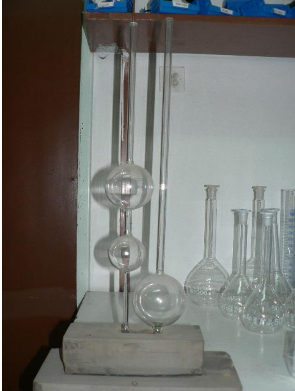
Şekil 3.8 Viskozite ölçümünde kullanılan U tipi boru düzeneği
