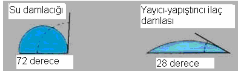
Şekil 1.4.Yayıcı-yapıştırıcı katkı maddeli damlacık ile su damlacığı değme açıları (Anonymous, 2005e)
