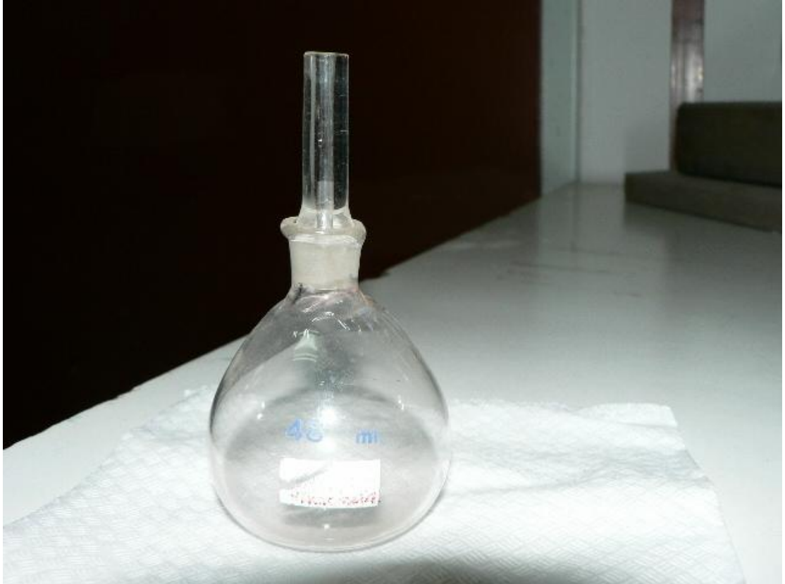
Şekil 3.7.Yoğunluk ölçümünde kullanılan sabit hacimli kap
