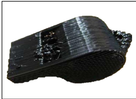
Şekil 1.27. Fazla ekstrüzyon hatası
