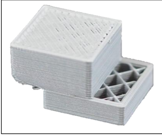
Şekil 1.29. Katman kayması hatası
