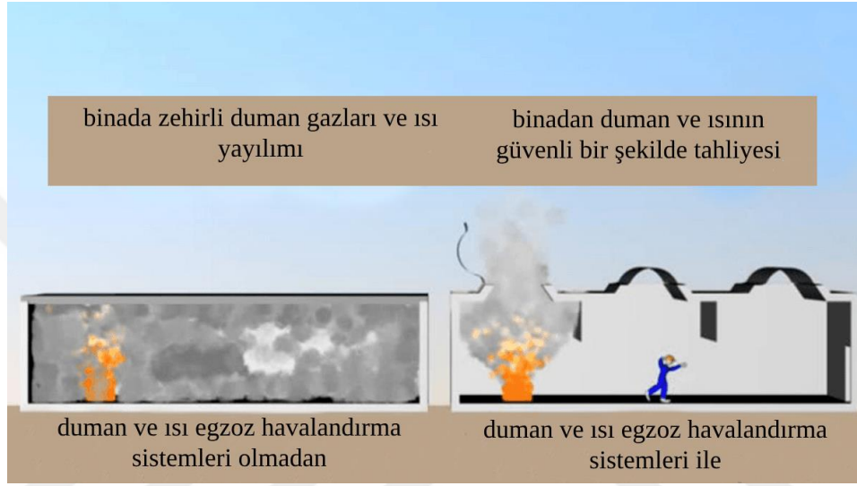
Şekil 4.44. Duman tahliye sisteminin çalışma mantığı (URL-40)
