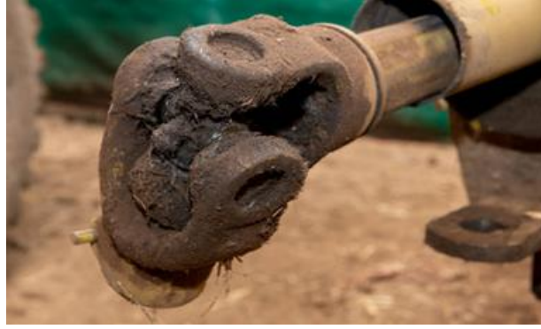
Şekil 4.23. Toz ve sap kalıntısı birikmiş şaft gövdesi (URL-33)
