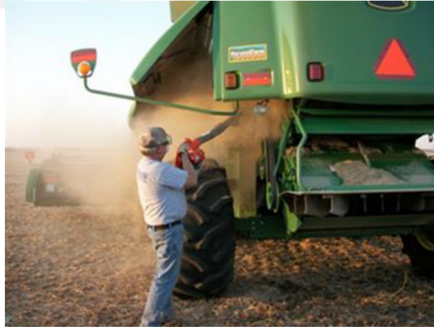
Şekil 4.27. Biçerdöver gövdesinde birikmiş tozun boyutu (URL-36)
