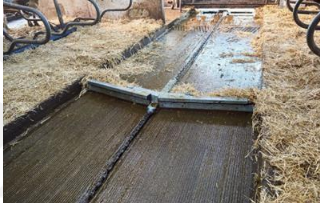
Şekil 4.24. Kuru altlık ile temas eden gübre sıyırıcı (URL-34)
