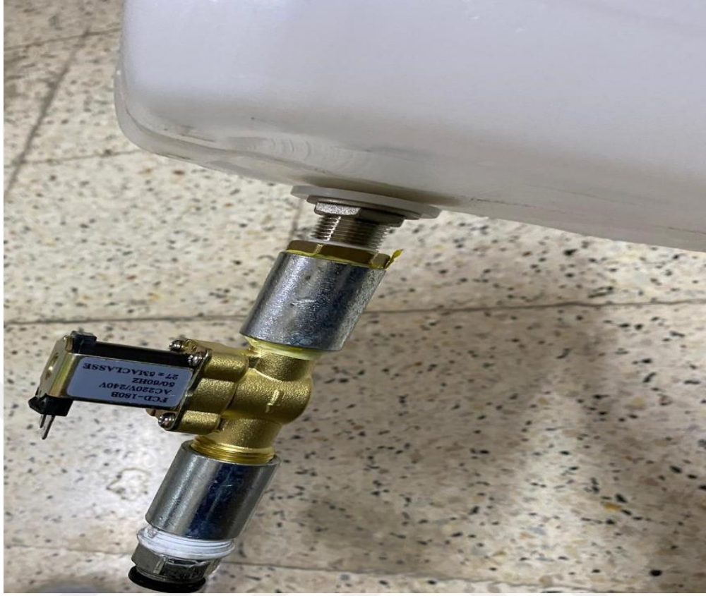
Şekil 4.3. Selenoid Valf Gübre Tankı Arası Bağlantı
