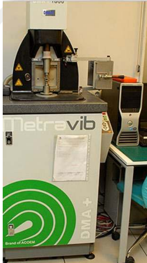
Şekil 2.16. Payne etkisinin incelendiği METRAVIB DMA +1000 cihazı.
