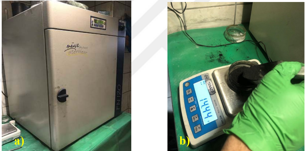
Şekil 2.8. a) Kül fırını b) FK'nin kül testi numunesi.
