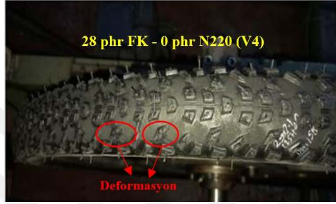
Şekil 3.12. Test sonrası lastiklerin görselleri, VRef (a), V1(b), V2(c), V3(d), V4(e).
