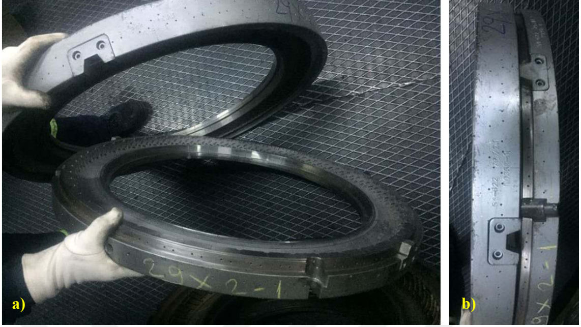
Şekil 1.6. a) Bisiklet lastiği pişirme kalıbı açık görseli, b) kalıbın kapalı görseli.
