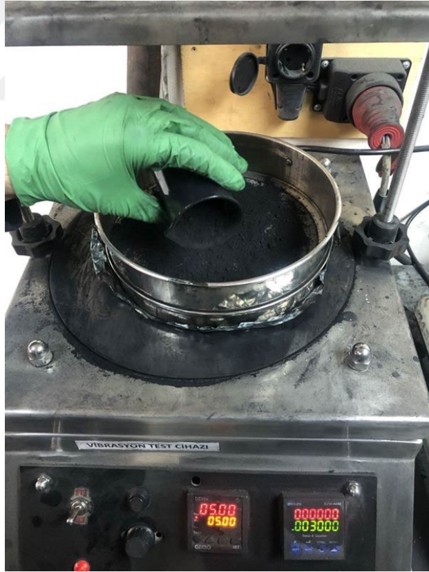
Şekil 2.6. FK’ye ait 325 mesh elek testi uygulaması.
