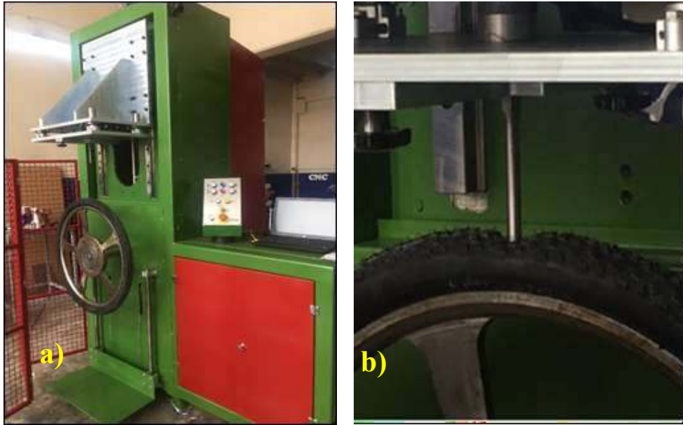
Şekil 2.17. a) Plunger test cihazı b) Test anından görsel.
