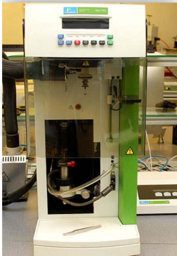
Şekil 2.14. TGA analizlerinin gerçekleştirildiği TGA PYRIS I cihazı.
