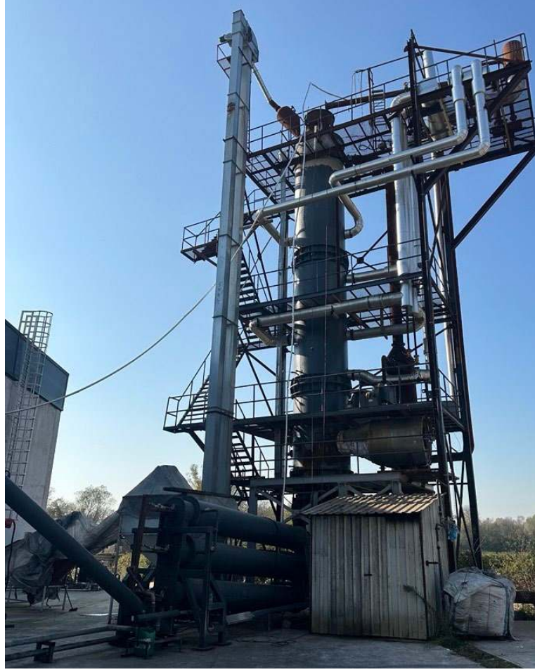
Şekil 2.2. Fındık kabuğundan karbon elde etmek için kullanılan piroliz reaktörü.
