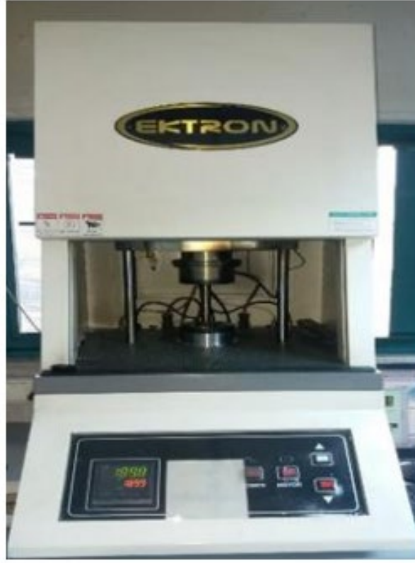
Şekil 2.11. EKTRON MDR 2000S- reometre test cihazı.
