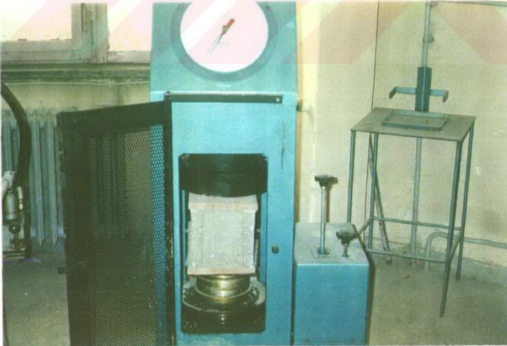
Şekil 3.8. Örneklerin basınç dayanımının ölçülmesi
