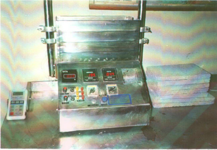
Şekil 3.11. Isı iletkenlik ölçüm cihazı
