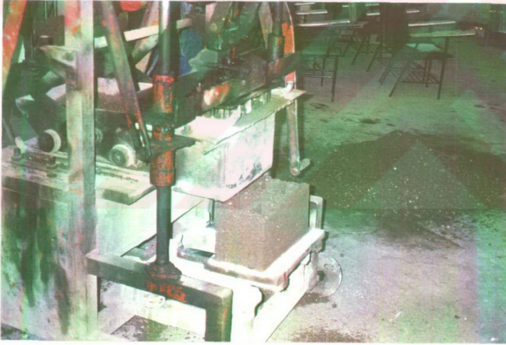
Şekil 3. 5. Taze beton blok betonunun birim hacim ağırlık deneyi
