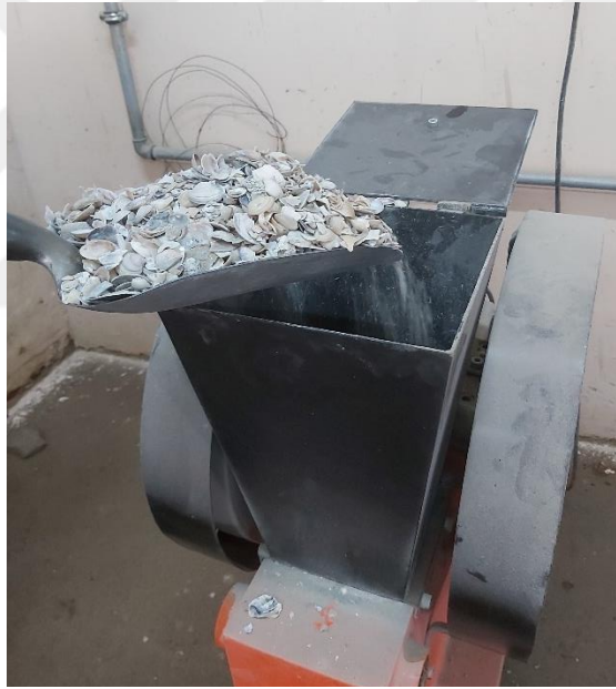
Şekil 14. Deniz kabuklarının mini konkasörde kırılması
