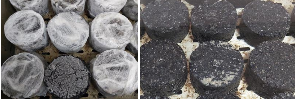
Şekil 20. Donma-çözünme döngüsü uygulanmış numuneler
