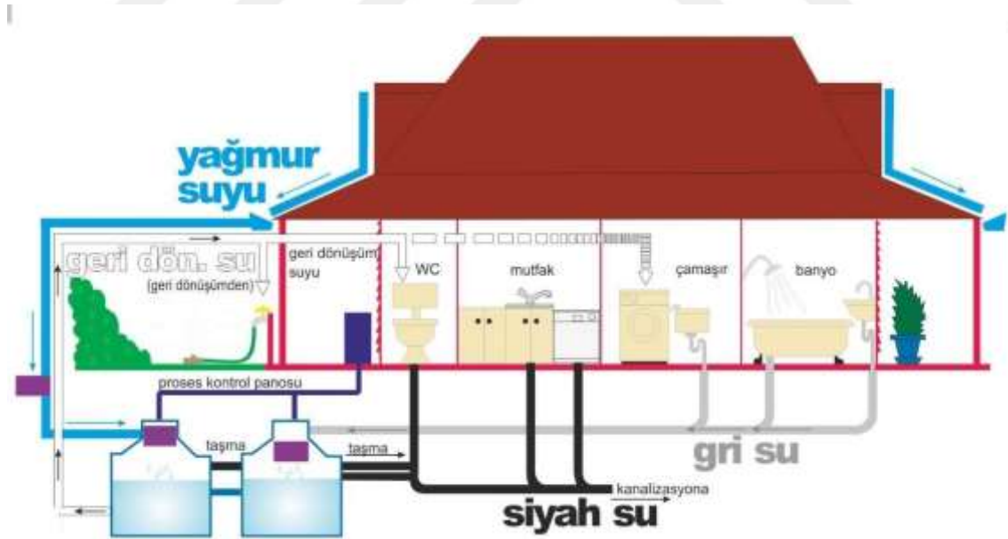
Şekil 3.18 Yağmur Suyu Toplama Modeli (Kantaroğlu, 2009)
