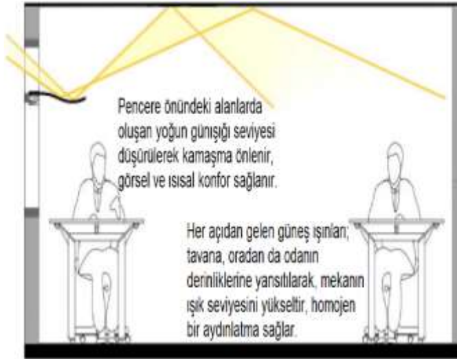
Şekil 3.12 Işık rafı modeli (Sevinç ve Altın, 2021)
