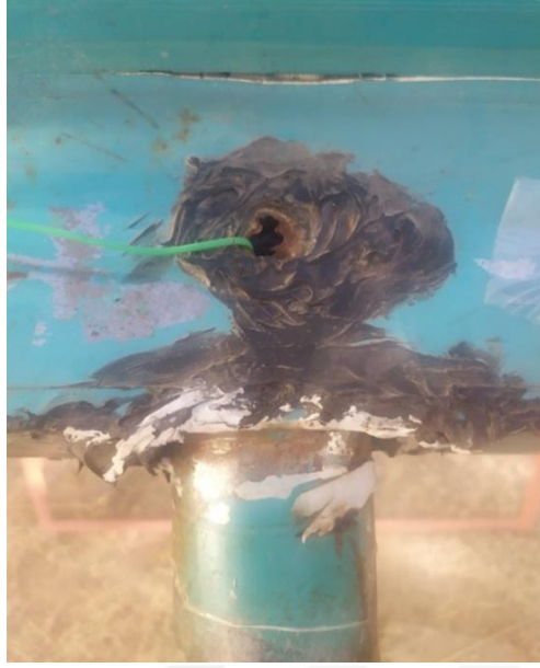
Şekil 5.25. Kolektör giriş ağzına yerleştirilen termokupl
