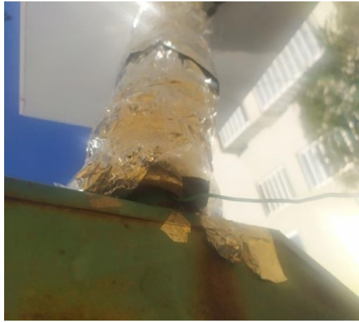
Şekil 5.27. Kolektör çıkış sıcaklığını ölçmek için yerleştirilen termokupl
