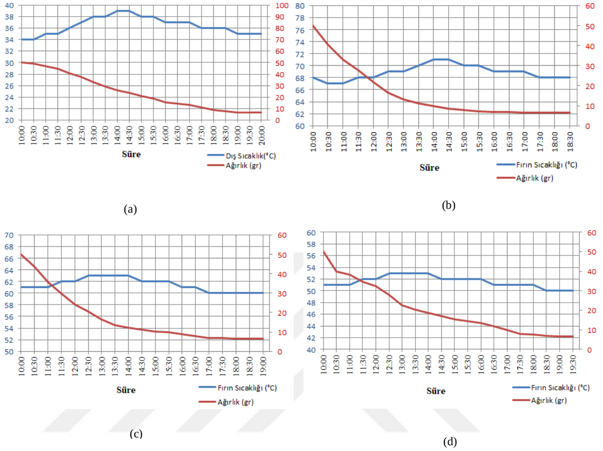
Şekil 6.6. Ağırlık-Sıcaklık-Zaman Grafiği (a) açık havada, (b) 70 °C'de, (c) 60 °C'de ve (d) 50 °C'de
