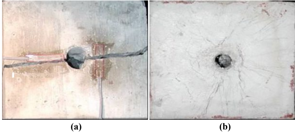
Şekil 2.9 Kırılma modları a) Beton numunesi ve b) ECC numunesi (Şahmaran ve Li, 2010)
