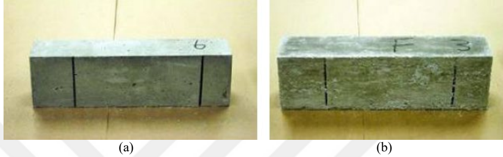
Şekil 2.7 ECC numunelerin çevrimlerden sonraki görüntüsü (a) ıslak kür ve (b) donma-çözülme etkisi (Şahmaran ve ark., 2009)
