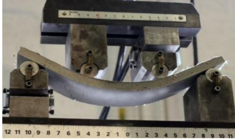
Şekil 2.1 ECC kompozitin eğilme yükleri altındaki sünek davranışı (Li, 1997)
