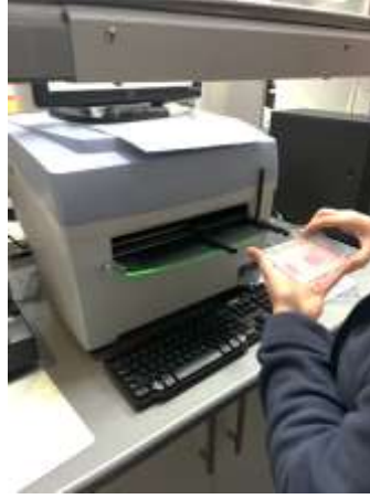
Şekil 3.46: Spektrofotometrik Plaka Okuyucu.
