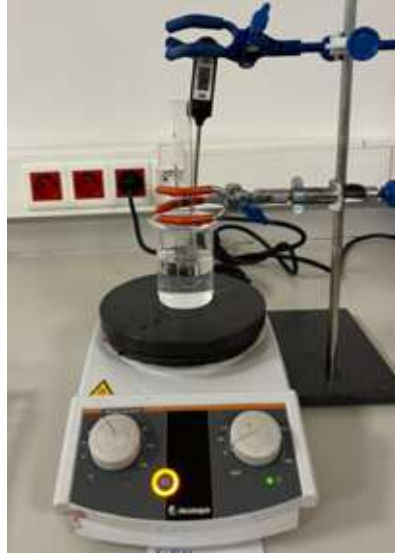
Şekil 3.9: Mekanik Karıştırıcı ve Isıtıcı.
