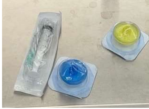
Şekil 3.40: Enjektör, 0,44'lik ve 0,22'lik Filtre.
