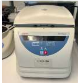
Şekil 3.49: Yüksek Hızlı Mikro Santrifüj.
