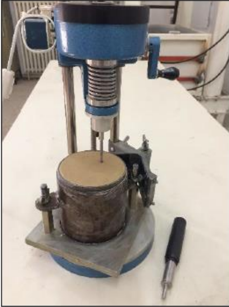
Şekil 2. 4. Laboratuvar Vane deneyi test ekipmanı (Acar, 2019)
