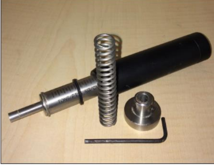
Şekil 2. 6. Cep penetrometresi ile drenajsız kayma dayanımı bulunması (Budak, 2020)
