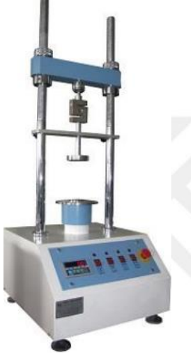
Şekil 2. 2. Tek eksenli deney aleti (Acar, 2019)
