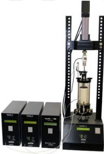
Şekil 2. 3. Üç eksenli deney aleti (Acar, 2019)
