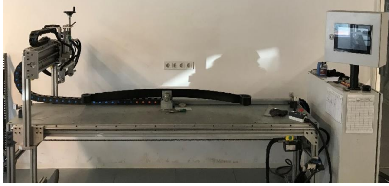
Şekil 5.13 Kavisli yaprak yay parabolik kalınlık ölçüm cihazı (Kişisel arşiv, 2021)
