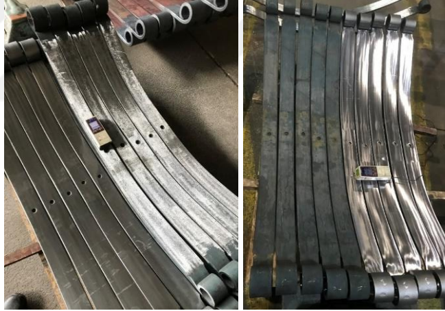
Şekil 5.3 Boyuna ve enine yüzey pürüzlülük ölçümleri (Kişisel arşiv, 2021)
