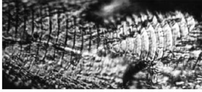
Şekil 4.3 Al-4%Cu alaşımlı bir malzemenin kırılma yüzeyinde oluşan mikroskopik ilerleme çizgileri (Pook, 2007)
