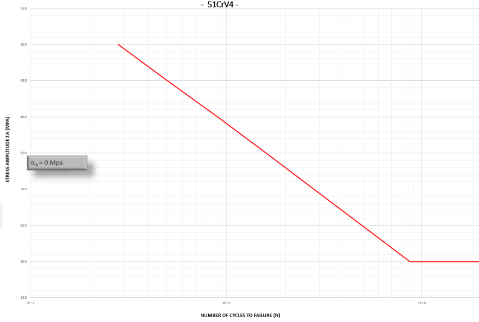
Şekil 5.59 51CrV4 malzeme için göz bölgesi S-N grafiği
