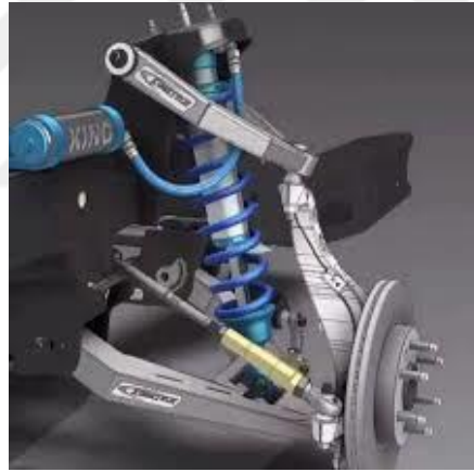
Şekil 2.2 Süspansiyon sisteminin ana unsurları (Goodarzi ve Khajepour, 2017)
