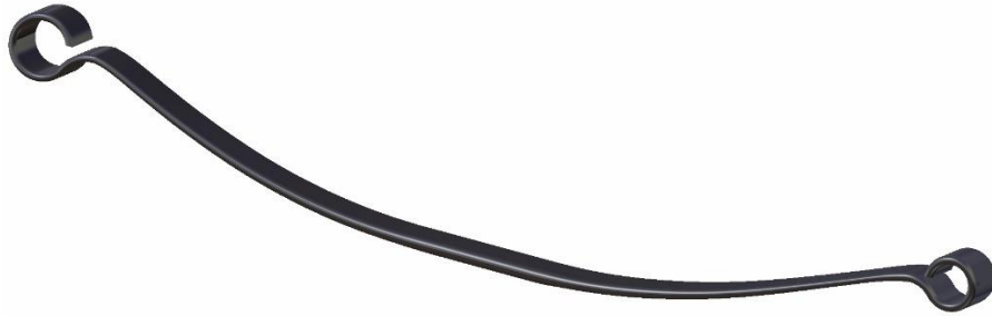
Şekil 5.15 Analizler için katı modele dönüştürülmüş yaprak yay
