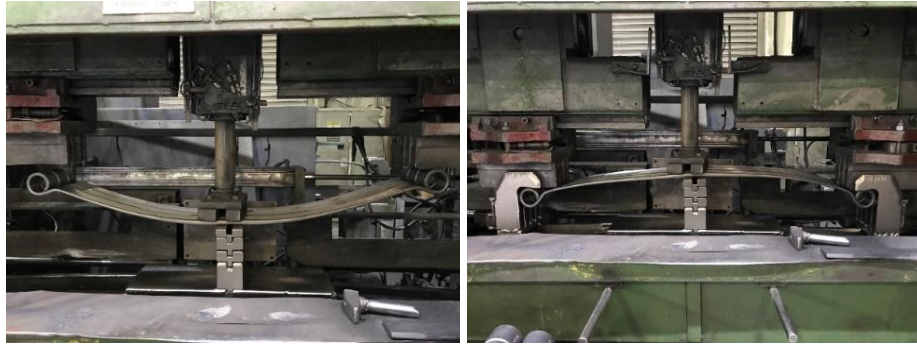
Şekil 5.4 Gerilim altında kumlama (Kişisel arşiv, 2021)
