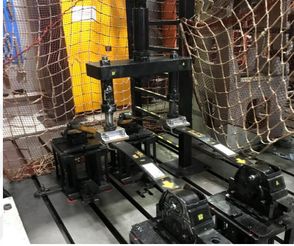
Şekil 5.24 Yorulma test görüntüsü (Kişisel arşiv, 2021)
