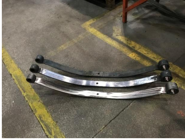
Şekil 5.2 Farklı yüzey temizlik işlemleri uygulanan yaprak yaylar (Kişisel arşiv, 2021)
