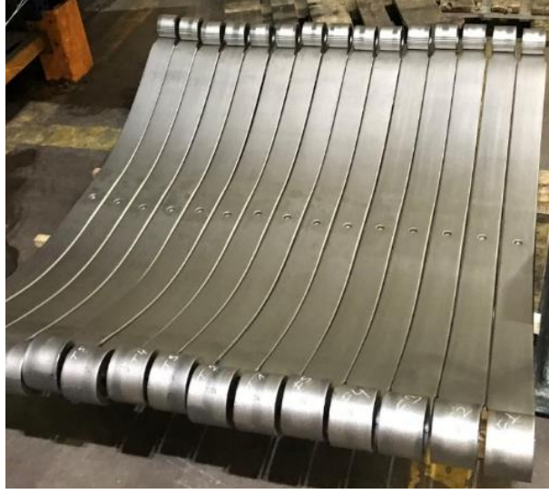
Şekil 5.5 Kumlama sonrası yaprak yaylar (Kişisel arşiv, 2021)
