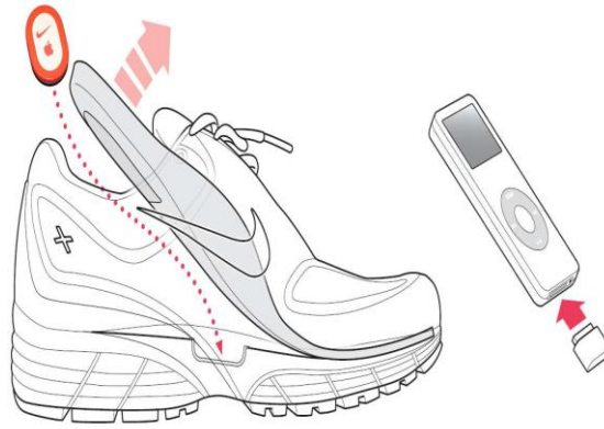
Şekil 3.56 : Nike+iPod sensörü Nike+ spor ayakkabısı ve iPod Nano'ya bağlanan Nike+iPod alıcısı (Saponas ve diğ, 2006).
